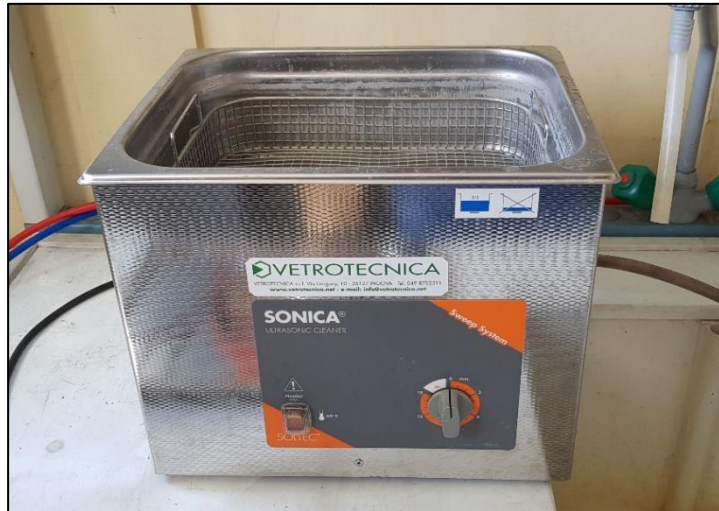
Figura 5.17: Macchina ad ultrasuoni ai Laboratori Nazionali di Legnaro per la pulizia di provini.
