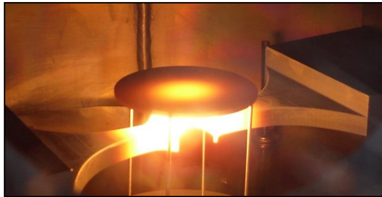
Figura 5.12: Elemento riscaldante per la prova a rottura dei provini utilizzati
