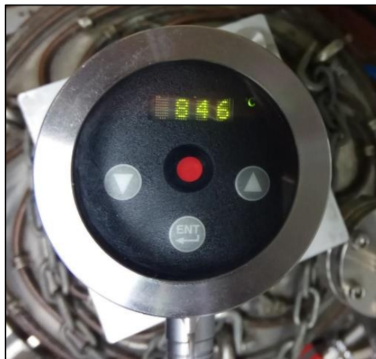
Figura 3.10: Lettura temperatura del pirometro presente ai Laboratori Nazionali di Legnaro.
