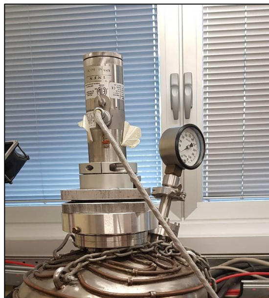
Figura 4.4: Immagine posizionamento pirometro sulla finestra di visione.
