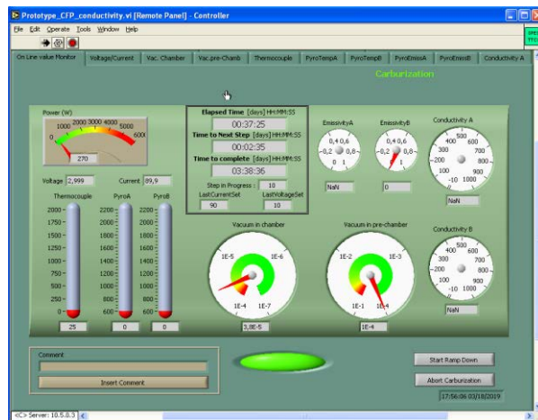
Figura 3.8: Finestra software Labview, per monitorare il passaggio dei parametri ed i tempi della rampa inserita.
