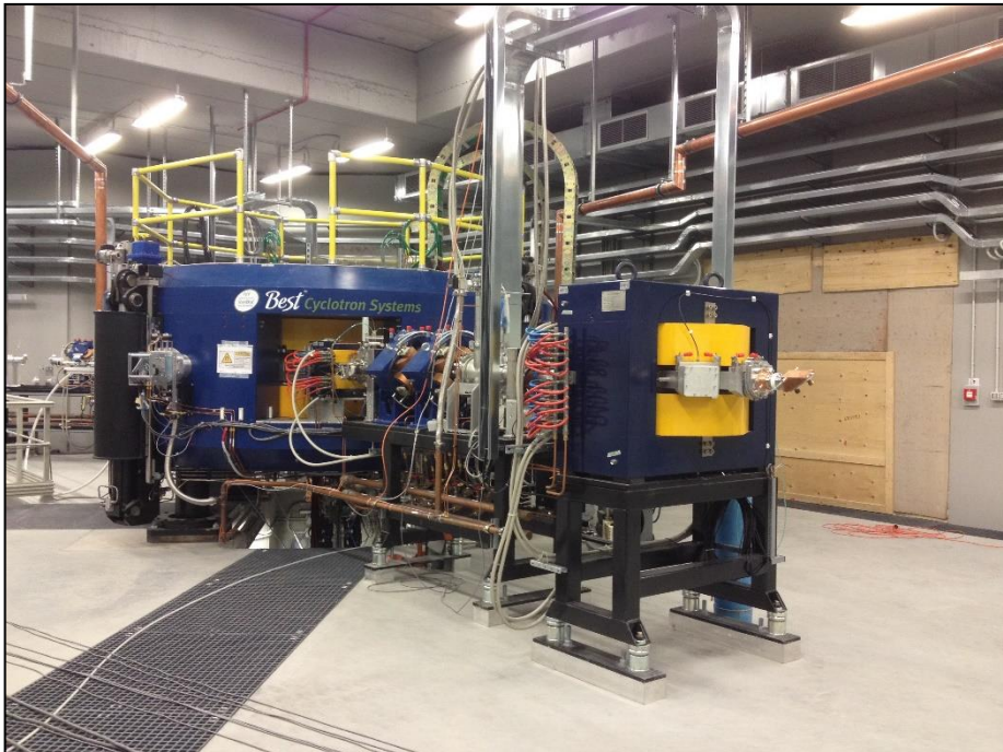
Figura 1.8: fotografia del ciclotrone BEST 70p sviluppato dalla Best Cyclotron Systems, Inc. presente all'interno della facility SPES ai Laboratori Nazionali di Legnaro.
