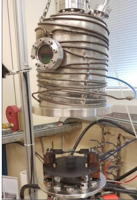
Figura 3.3: Impianto presso i Laboratori Nazionali di Legnaro per il calcolo dell'emissività dei materiali ed i test di riscaldamento.
