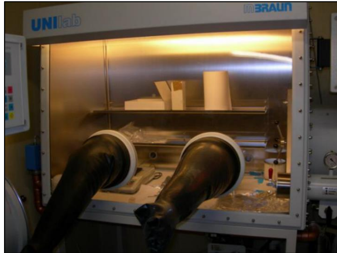
Figura 2.1: glove box presente ai Laboratori Nazionali di Legnaro.
