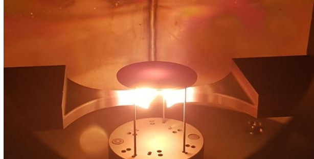
Figura 3.5: Crogiolo in grafite POCO EDM-3 riscaldato per effetto Joule, con provino per la conducibilità SiC SA.
