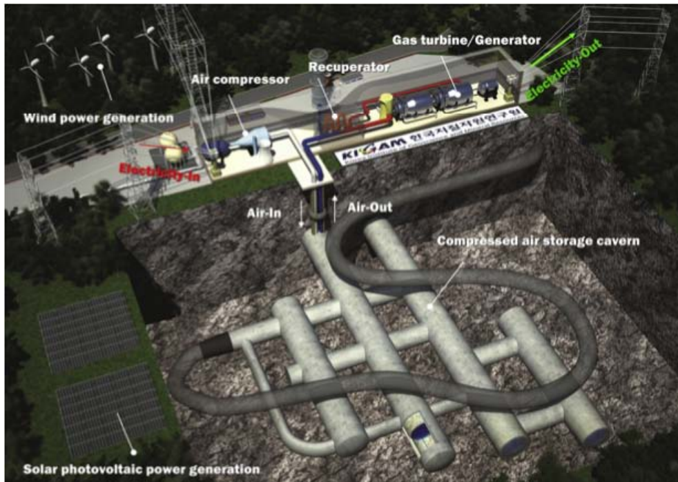
Figura 2.1: Componenti di un sistema CAES sotto terra.
