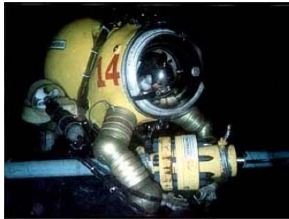
Figura 8.9: WASP ADS - Installazione di un connettore senza saldature. Sorgente: Oceaneering.
