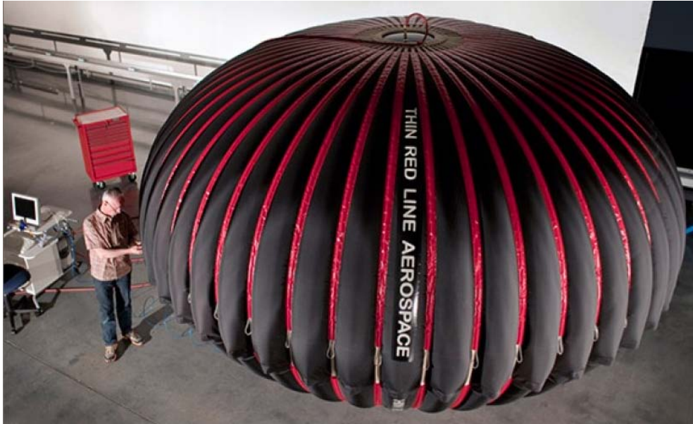
Figura 3.3: Pallone per lo stoccaggio di aria compressa della Thin Red Line Aerospace Ltd.
