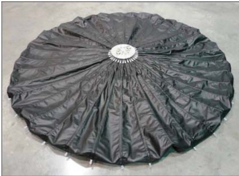
Figura 4.2: Un prototipo di Energy Bag ad architettura UHPV e relative increspature dovuto all'accorciamento dei tendini.
