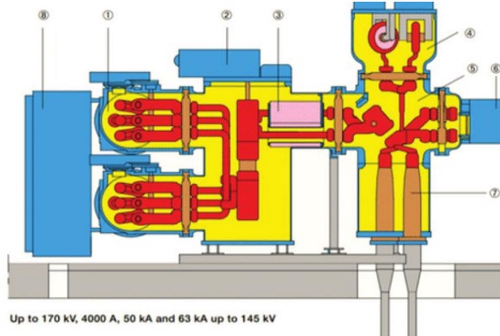
I Gas Insulated Switchgears (GIS) sono dei quadri elettrici progettati per controllare e proteggere i circuiti elettrici. Sono costituiti da un involucro metallico a tenuta ermetica, che funge da schermatura elettromagnetica e da protezione meccanica. All'interno dell'involucro si trovano tutti i vari componenti, come interruttori, sezionatori, unità terminali del cavo, messe a terra, trasformatori di tensione e corrente, e gas isolante.
