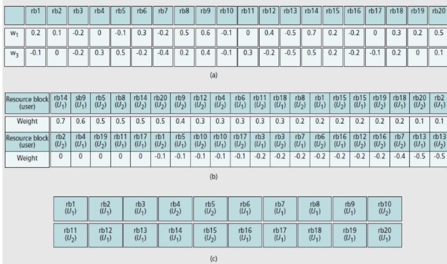
Fig. 3.2: Esempio di allocazione delle risorse con Algoritmo 4: a) vettori risultanti per ciascun utente; b) vettore ordinato dei valori per ogni utente su ogni RB; c) risultato dell'allocazione (tratto da [5])
