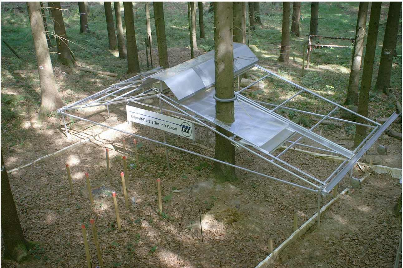
Fig. 2.2: Struttura con tetto di chiusura per l'esclusione della pioggia (Umwelt-Geräte-Technik GmbH, Germany)
