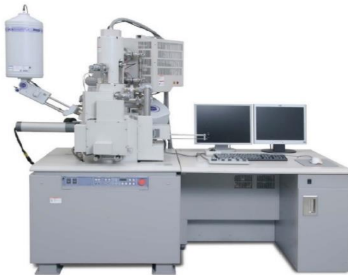
Figura 4.9: microscopio elettronico a scansione FEI Quanta 200 ESEM, FEI, Hillsboro, OR, USA.
