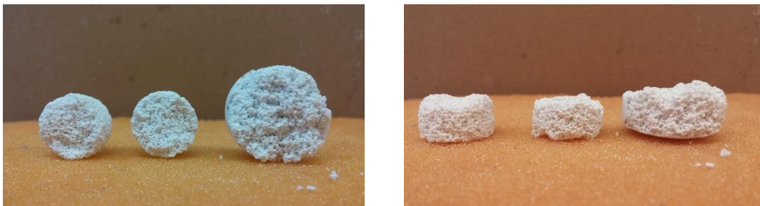
Figura 4.11: particolare dei campioni di BioAmo allo stadio di “verde”.
