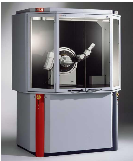
Figura 4.8: diffrattometro a raggi X (analisi XRD).
