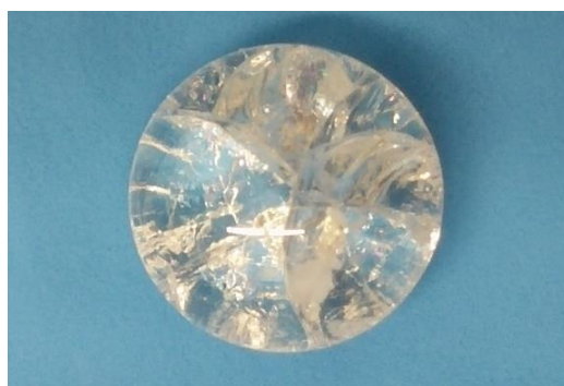
Figura 4.1: particolare della fritta prodotta a partire dalla composizione di BioAmo. La trasparenza è simbolo della mancata cristallizzazione del vetro, che ha mantenuto una struttura amorfa.
