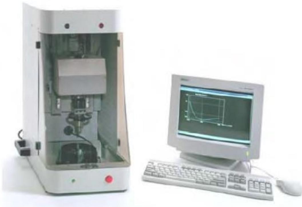
*Figura 4.7. Tribometro UMT 3 by Brunker utilizzato per le prove di trazione sui trucioli*
