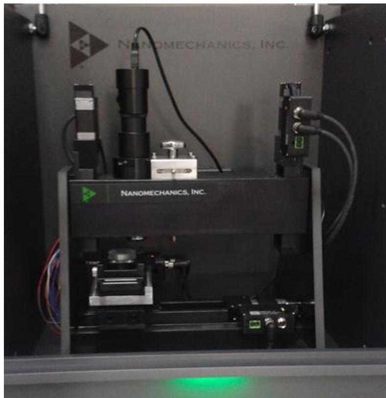
*Figura 4.6. Nano-durometro usato per effettuare le misure di nano-durezza*
