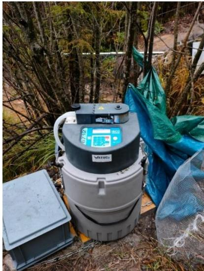
*Figura 12: Campionatore automatico modello Teledune ISCO 6712, posizionato alla sezione di chiusura*
