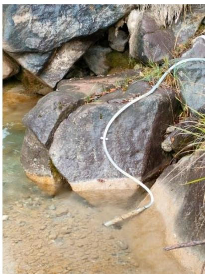
*Figura 13: Sonda immersa in acqua, collegata al campionatore da un tubo in pvc*
