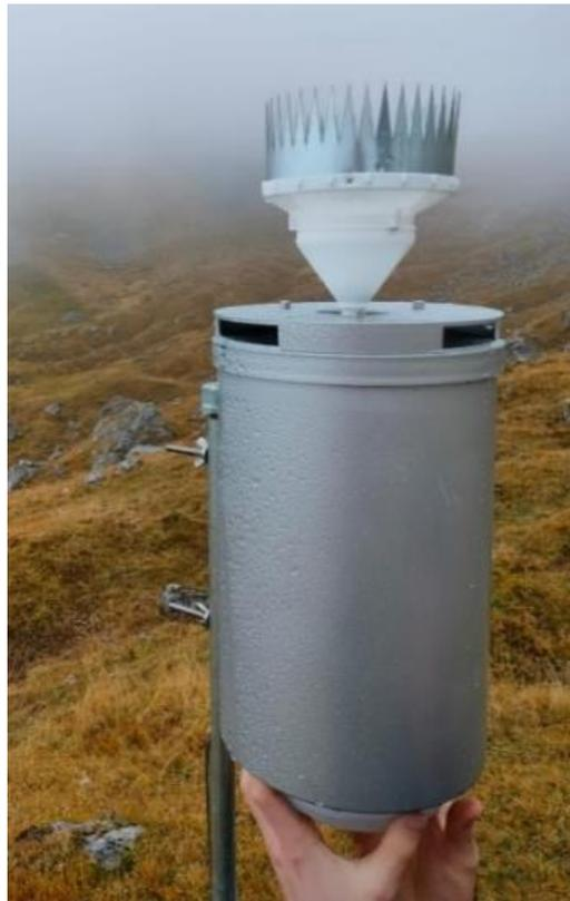
*Figura 11: Pluviometro Palmex Rain Sampler RS-1C posizionato nella stazione meteo monte*
