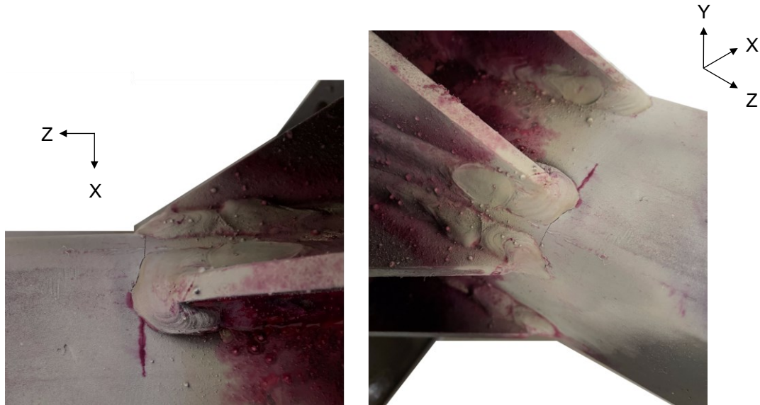
Figura 7.13 Analisi con liquidi penetranti eseguita sul giunto sollecitato a flessione pura B_AW_0.05_11200_11200. Come si può notare sono presenti due punti dai quali la cricca sembra essere innescata: uno in corrispondenza dell'apice dell'irrigiditore e uno in corrispondenza del tratto curvo del cordone di saldatura.
