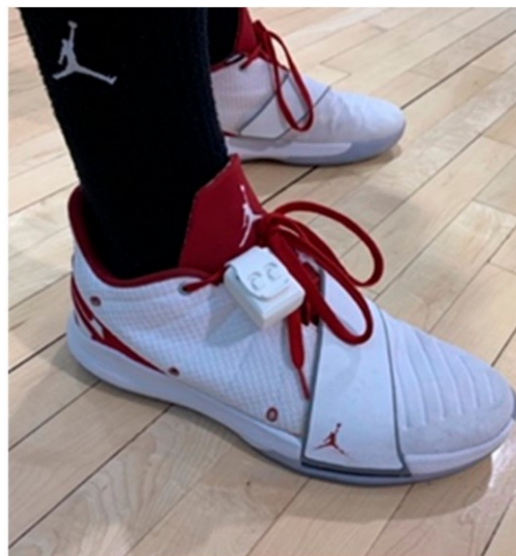
Figura 7. Sensore del sistema di posizionamento (IPS) posto nella guaina protettiva in gomma sul laccio della scarpa dell'atleta.
