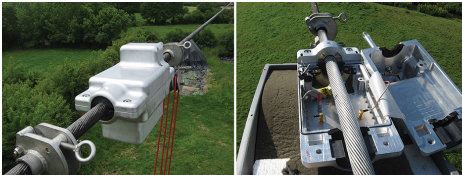
Figura 4.6: Ampacimon installato su una corda - Dispositivo aperto
