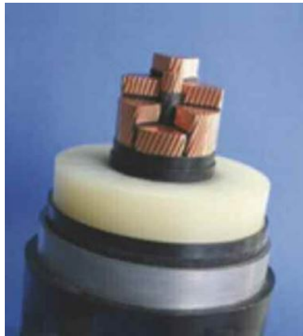
Figura 2.9: Cavo Milliken a sei settori isolato in XLPE
