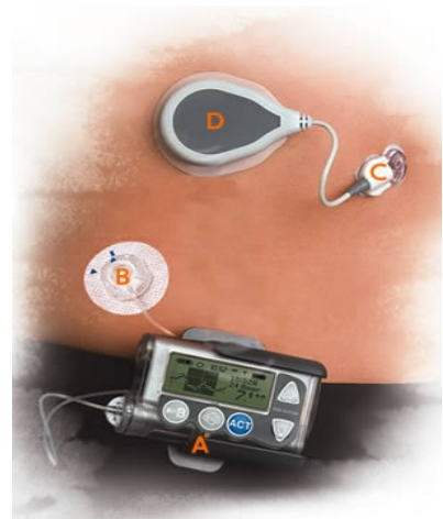
Figura B.1 : il Pancreas Artificiale : A-Microcomputer B-Infusore Insulinico C-Sensore Monitoraggio Continuo D-Rilevatore
