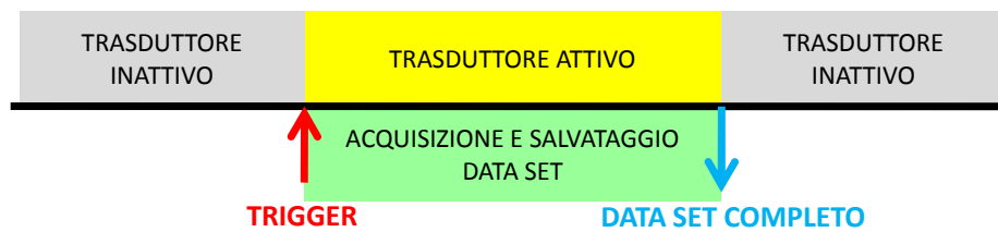
Figura 2.4: schematizzazione temporale di un campionamento Trigger-initiated
