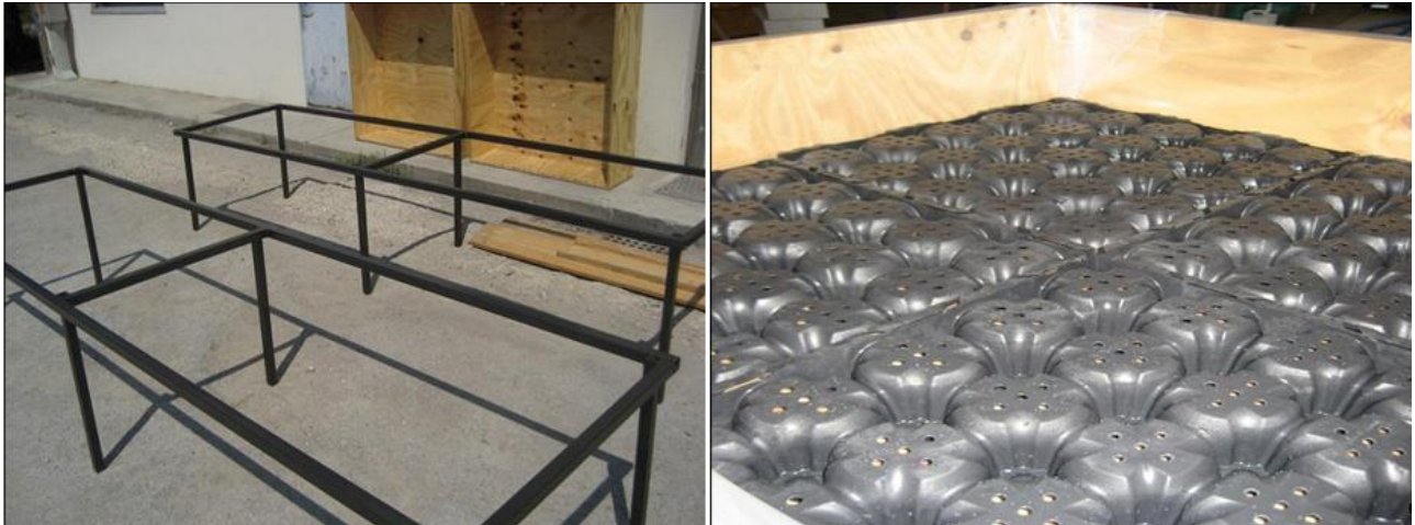
Foto 3: a) Cavalletti di supporto verniciati; b) Materiale drenante GEODREIN®
