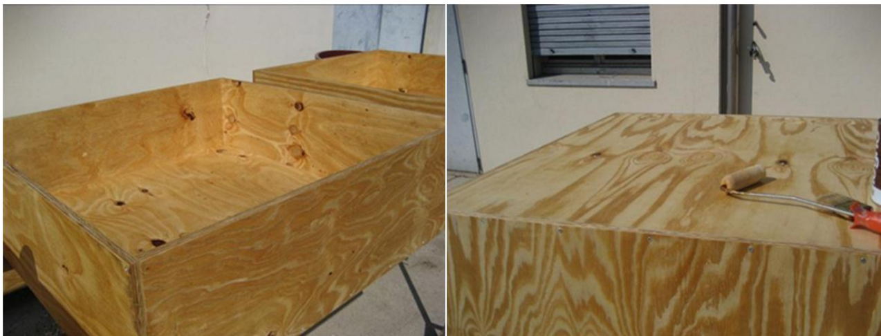
Foto 1: a) Legno assemblato in cassoni da (1 x 1 x 0,30) m; b) Impregnante su cassoni ultimati
