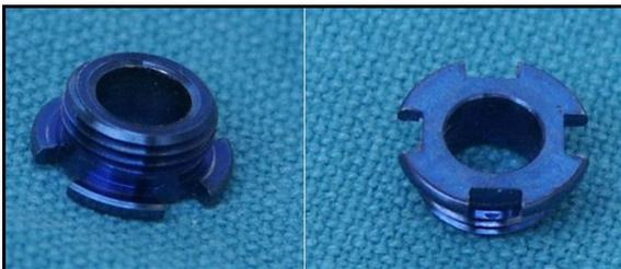
**Fig. 4.2** – Bussola *fixin*™. Si nota la porzione esterna filettata per essere avvitata all'apposito foro del supporto e la porzione interna conica capace di accogliere la complementare testa della vite.
