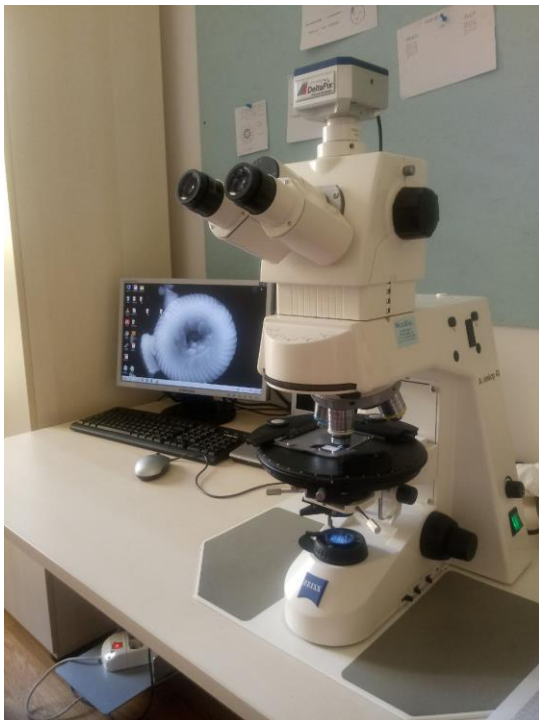
Figura 3.3 Microscopio ottico polarizzatore utilizzato per l'analisi di dati del Site U1507B.
