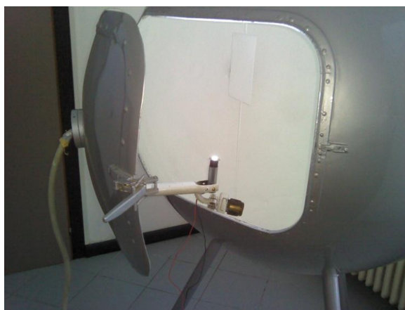
Figura 3.16 posizionamento del Led per la prova termica
