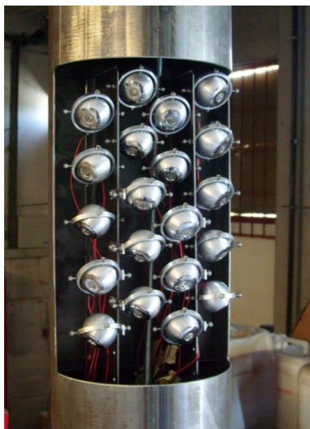
Figura 3.20: Fotografia del corpo illuminante della lampada con le sfere orientate
