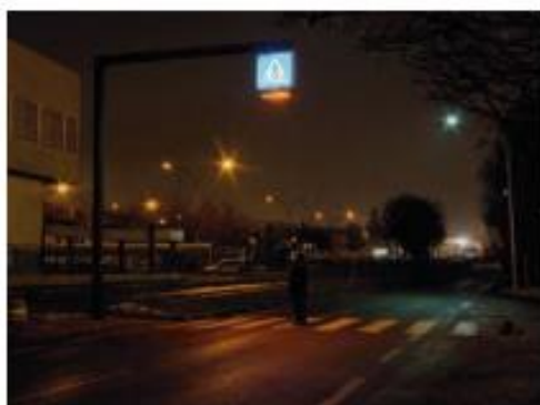
Figura 2.2 Pedone illuminato in modo sbagliato
