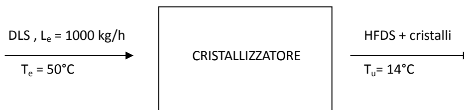
Fig 5.5 Schema per il bilancio di energia sul cristallizzatore
