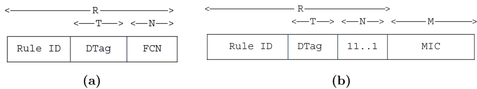
Figura 3.15: Rappresentazione della struttura dell'header di un frammento nella modalità No ACK. Con (a) raffigurante tutti i frammenti eccetto l'ultimo descritto dalla figura (b).
