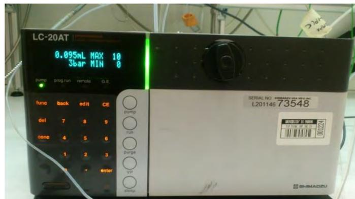
*Figura 12: Pompa da HPLC. A sinistra il pannello di controllo, al centro manopola per azionare la linea di spurgo*
