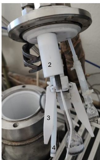
Figura 30. Componenti collegate alla testa del reattore e impiegate nei test catalitici.
