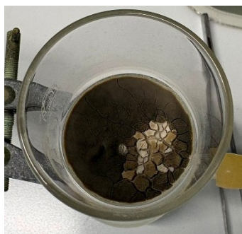
Figura 39. Polidivinilbenzene solfonato e metallato durante l'essiccazione sotto cappa.
