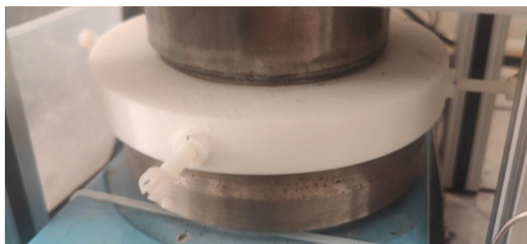
Figura 45. Strumento in plastica, con viti per il fissaggio, in grado di impedire lo spostamento del reattore dall'asse di mescolamento
