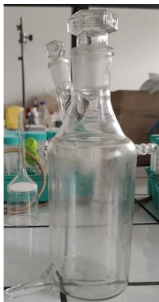
Figura 24. Reattore in vetro incamiciato per la solfonazione del polidivinilbenzene.
