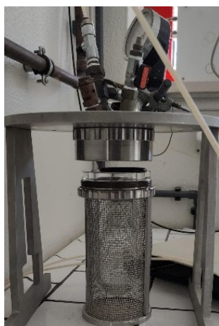
Figura 27. Reattore in vetro per la riduzione del palladio supportato su pDVB-SO 3 H.
