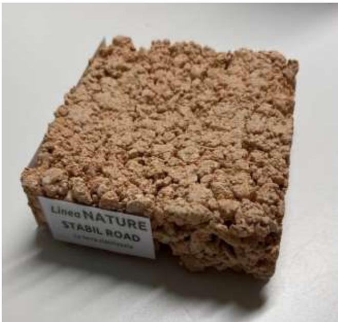
Figura 5 - Modello stabilizzato drenante
