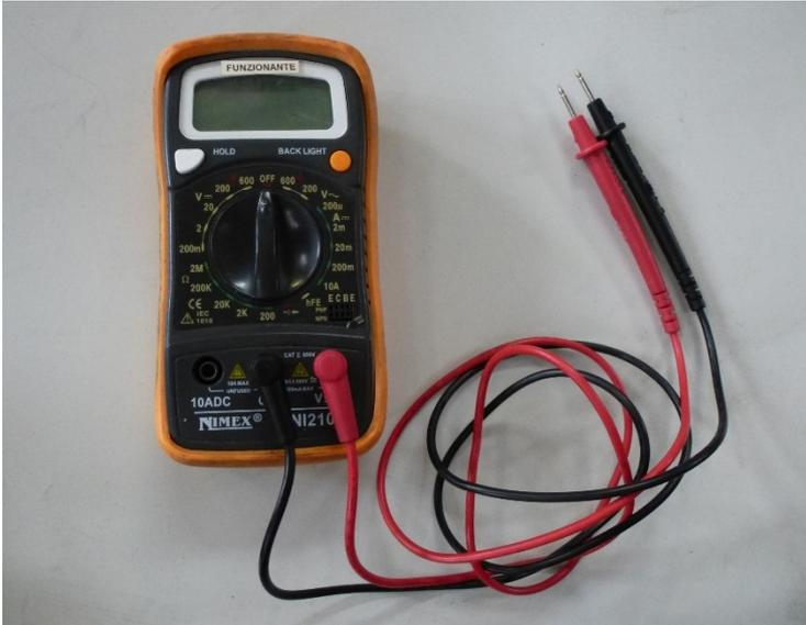
Figura 6-30: multimetro utilizzato per le misure di resistenza
