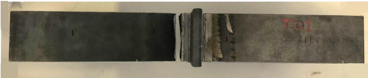
Figura 5-21: giunto T01, separato in due parti dopo la prova a fatica ad ampiezza costante
