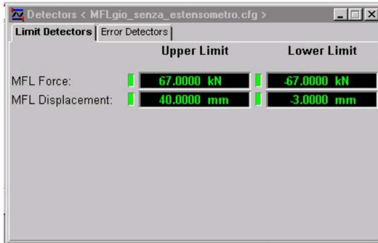
Figura 5-6: schermata per la modifica dei limiti imposti allo spostamento e alla forza
