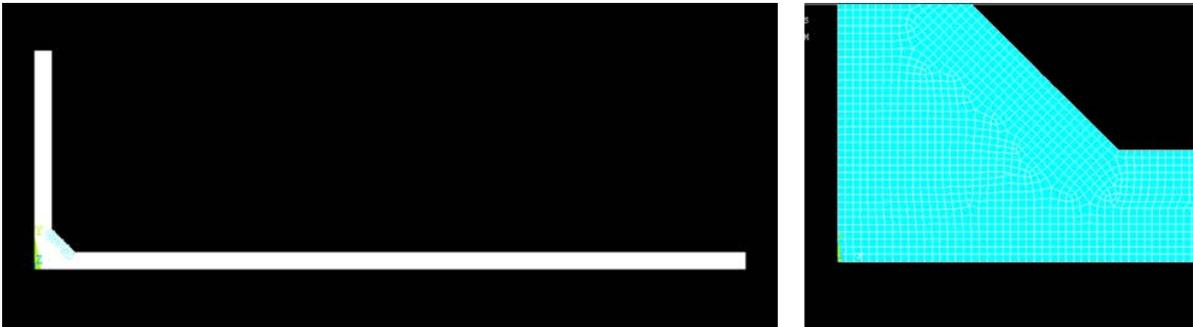
Figura 7-53: mesh realizzata per il giunto in figura 7.50 (sinistra), e dettaglio della stessa a piede cordone (destra)
