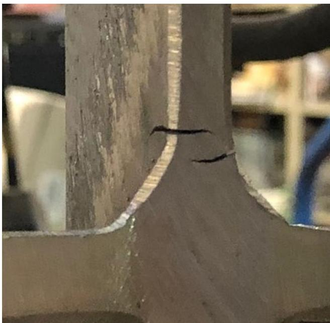
Figura 5-35: giunto I11 con cricche propagate
