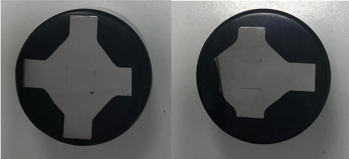
Figura 6-50: campioni di giunti inglobati in resina, e lucidati tramite levigatrici metallografiche
