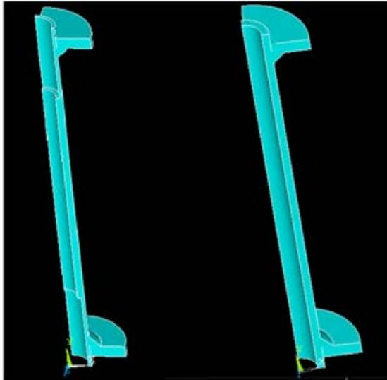
Figura 3-20: geometrie tridimensionali realizzate per l'analisi del giunto con elemento SOLID285 a 4 nodi
