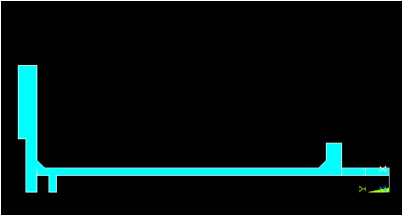
Figura 7-46: geometria realizzata per l'analisi agli elementi finiti del giunto in figura 7.45
