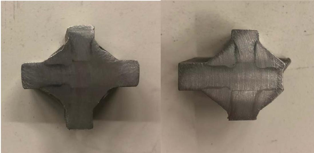
*Figura 6-48: porzione di giunto separata dal totale del provino per effettuare le prove di microdurezza, per T07, giunto non testato a fatica (a sinistra) e T04, giunto testato a fatica (a destra).*
