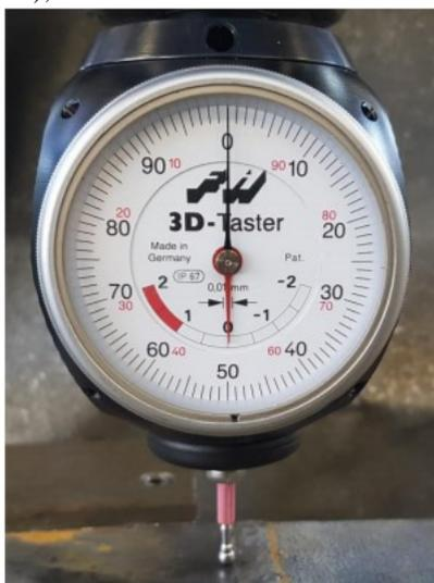
Figura 6-5: tastatore della fresa utilizzato per le misure di disallineamento
