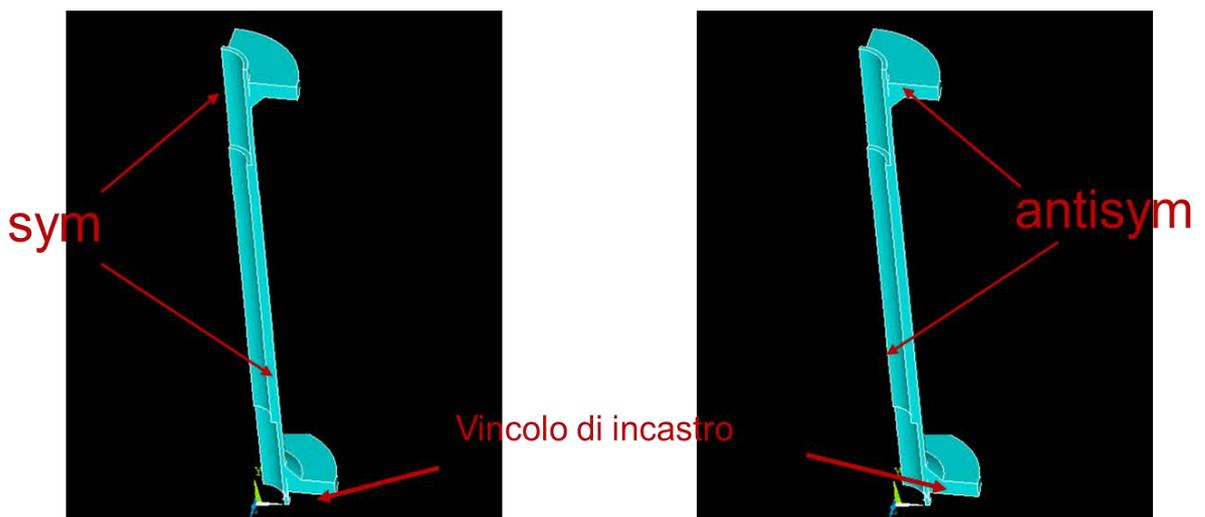
Figura 3-21: vincoli assegnati al caso geometrico a, a sinistra caso di carico di trazione, a destra torsione
