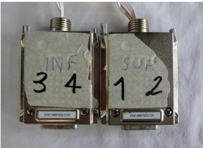
Figura 6-31: connettori a cui sono collegati due estensimetri ciascuno, si noti che è presente la denominazione degli estensimetri collegati a ciascun connettore.
