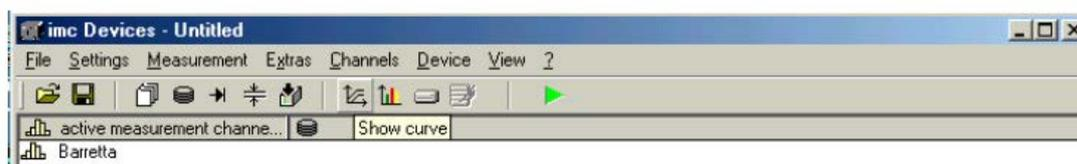
Figura 6-37: icona "show curve" per mostrare a video l'andamento delle quantità misurate durante l'acquisizione
