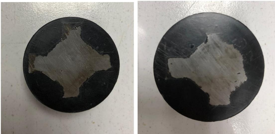
*Figura 6-49: campioni di giunto inglobati in resina, a sinistra T07 (non testato a fatica), a destra T04 (testato a fatica)*
