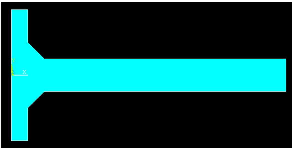
Figura 7-2: geometria realizzata per l'analisi agli elementi finiti del giunto in figura 7.1
