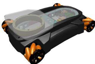
Figura 1.5: Piattaforma omnidirezionale di KUKA youBot.
