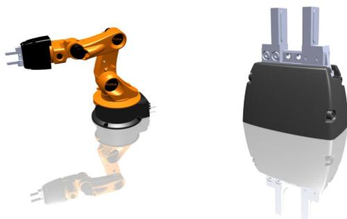
Figura 1.6: Braccio e gripper di KUKA youBot
