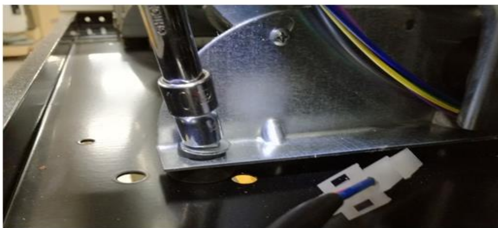
Fig. 5.15. Una porzione delle SOP: il montaggio del ventilatore
