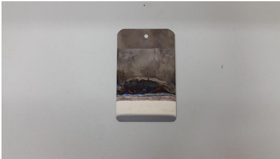
Figura 7.6 Campione anodizzato con processo ottimizzato.
