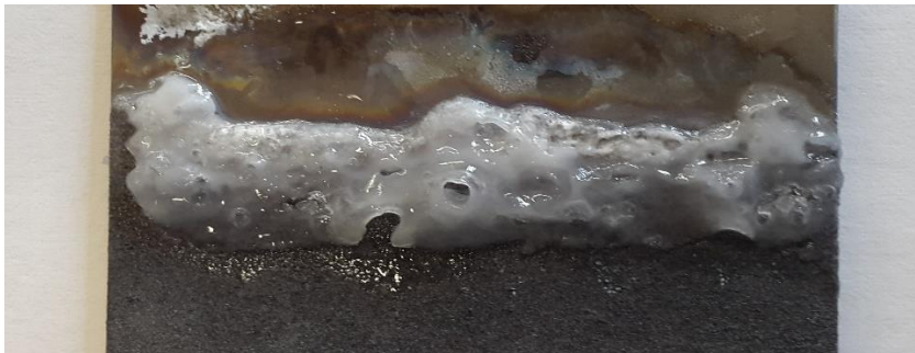
Figura 5.9 Deposito di sale tipico dell'anodizzazione in soluzione 1.
