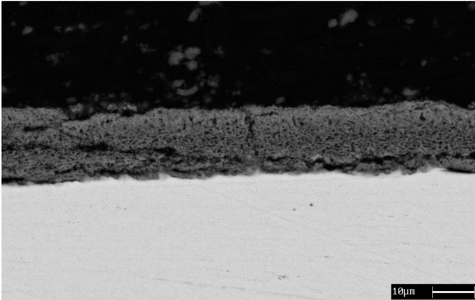
Figura 7.10 Micrografia del campione anodizzato con processo ottimizzato a medio ingrandimento.
