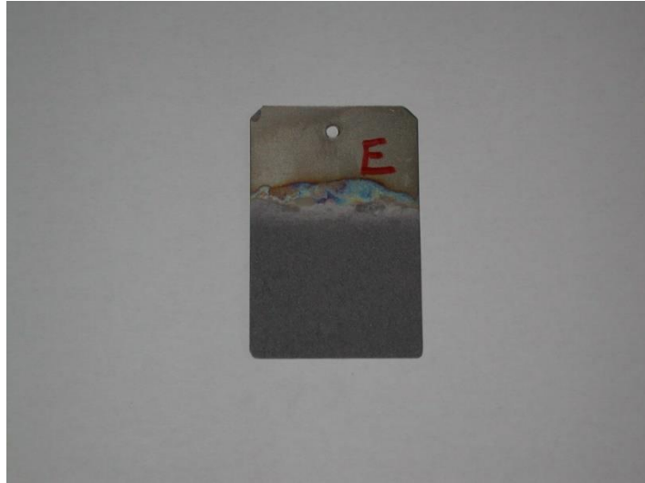
Figura 5.7 Campione A anodizzato con t = 60\text{min} e con soluzione elettrolitica 1.
