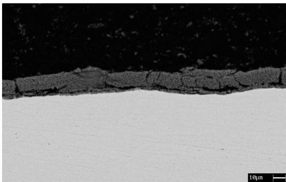
Figura 7.9 Micrografia del campione anodizzato con processo ottimizzato a basso ingrandimento.
