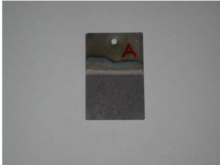
Figura 5.3 Campione A anodizzato con t = 30\text{min} e con soluzione elettrolitica 1.
