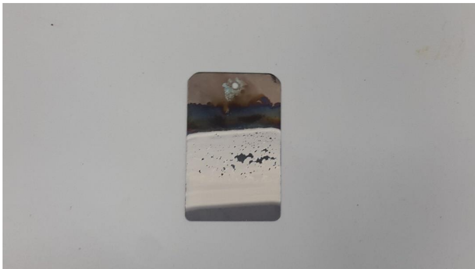
Figura 7.3 Campione anodizzato con t = 60\text{min} e \Delta V = 140\text{ V} .
