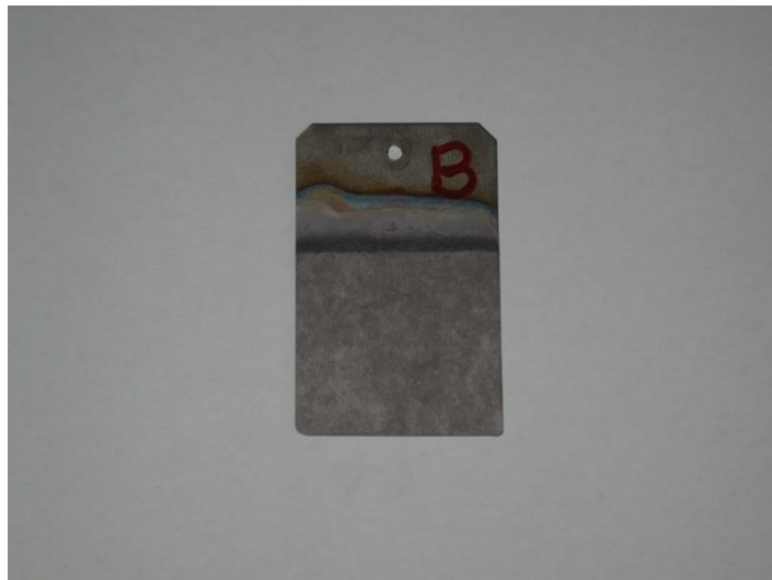
Figura 5.4 Campione B anodizzato con t = 30\text{min} e con soluzione elettrolitica 2.
