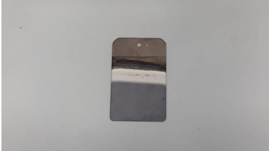
Figura 7.2 Campione anodizzato con t = 10\text{min} e \Delta V = 140\text{ V} .
