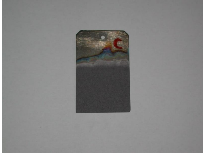
Figura 5.5 Campione A anodizzato con t = 45\text{min} e con soluzione elettrolitica 1.
