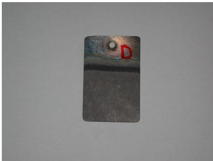
Figura 5.6 Campione B anodizzato con t = 45\text{min} e con soluzione elettrolitica 2.
