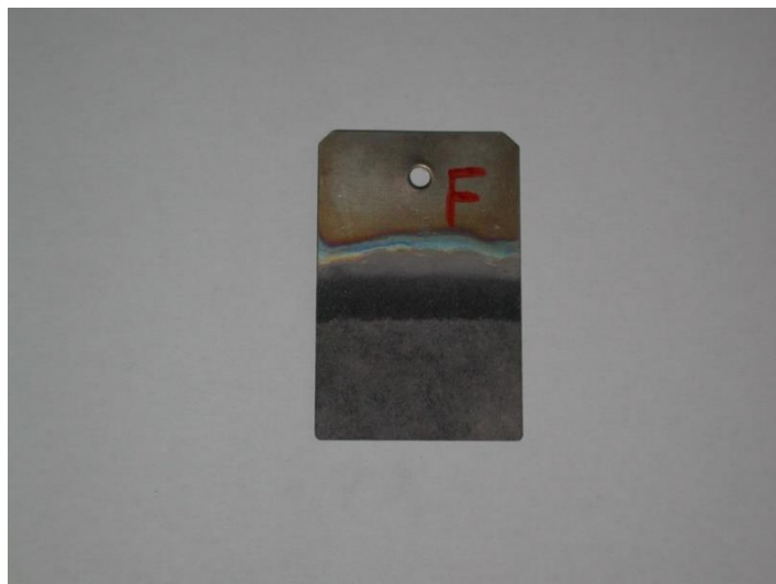
Figura 5.8 Campione B anodizzato con t = 60\text{min} e con soluzione elettrolitica 2.
