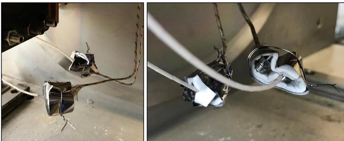
Figura 4. 20: Schermatura collegamento termocoppie – cavi di estensione
