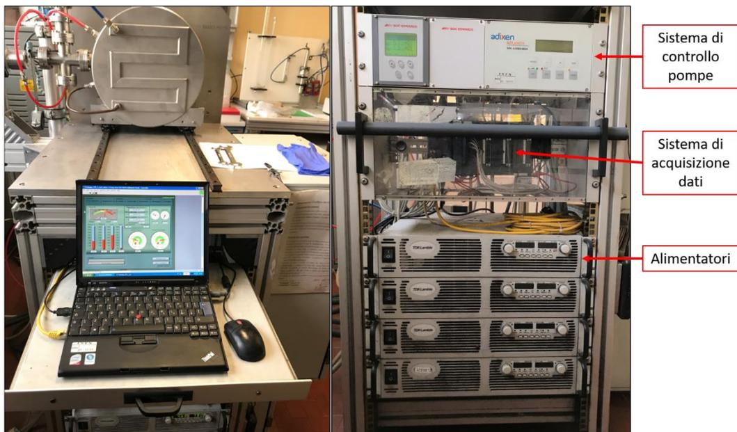
Figura 2. 18: Interfaccia di comando per i trattamenti sulla sinistra, rack con alimentatori e sistemi ausiliari sulla destra
