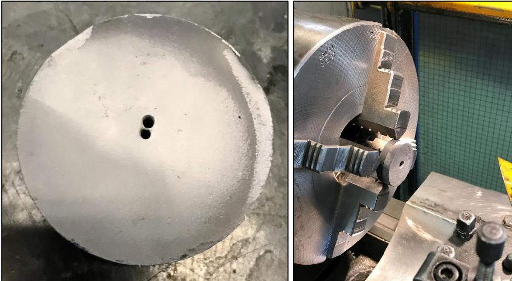
Figura 4. 9: A sinistra un tappo con i depositi; a destra la rimozione di essi
