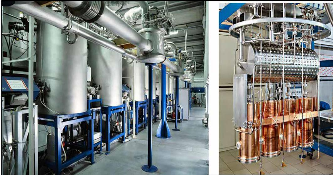
Figura 1. 17: Porzione del linac ALPI e relativi criostati (sinistra); Interno di un criostato (destra)
