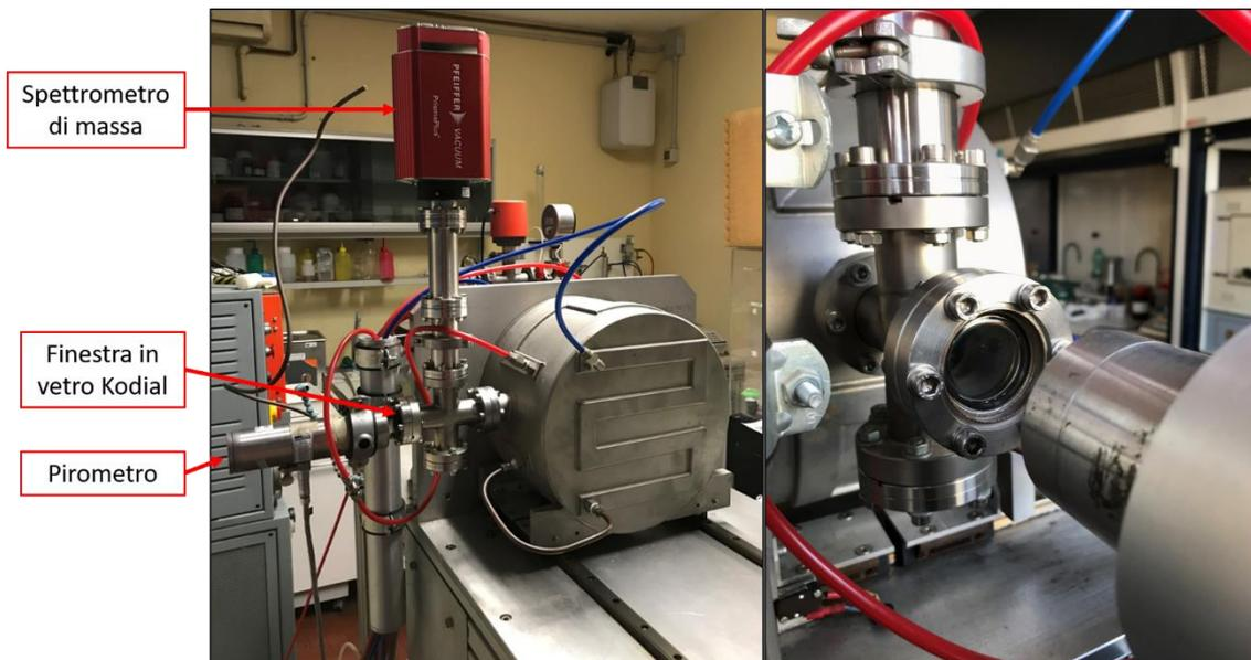
Figura 2. 15: Layout della camera e dettaglio della finestra in vetro Kodial
