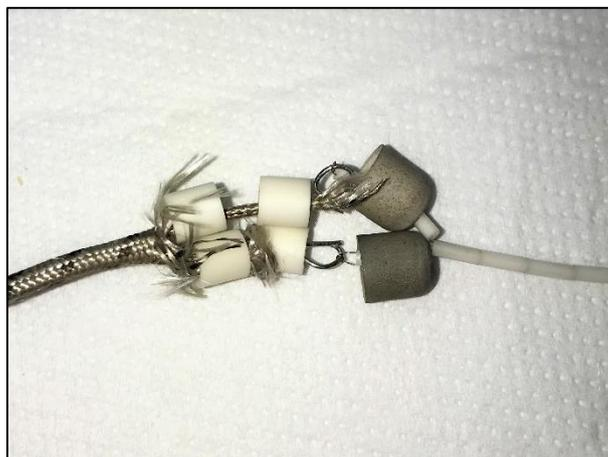
Figura 4. 22: Collegamento tra termocoppie – cavi di estensione
