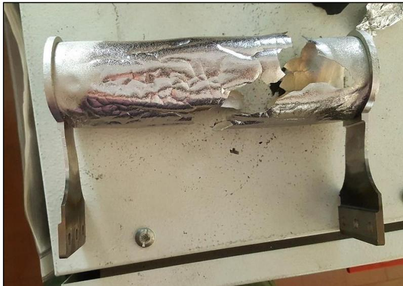
Figura 2. 19: Elemento riscaldante rotto
