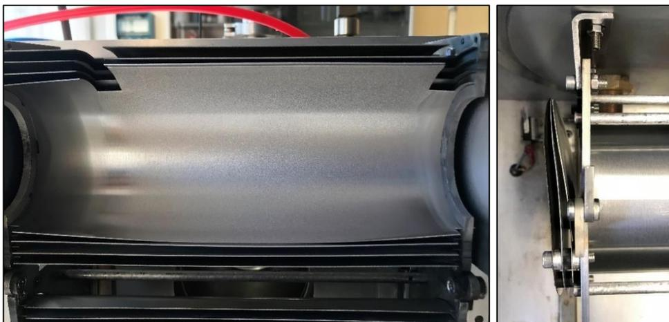
Figura 5. 1: Schermo bombato e con segni di ricristallizzazione (sinistra); schermi laterali curvati (destra)
