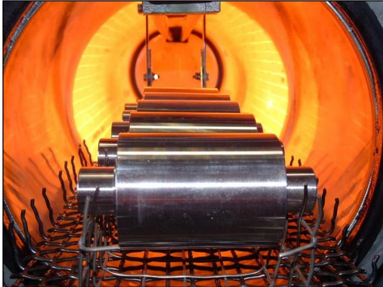
Figura 2. 3: Pezzi in ingresso in un forno per trattamenti termici
