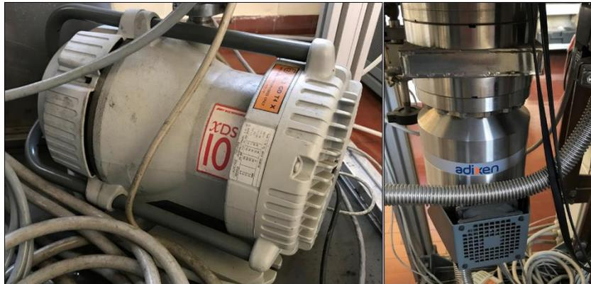
Figura 2. 17: Pompa rotativa sulla sinistra, pompa turbo – molecolare sulla destra
