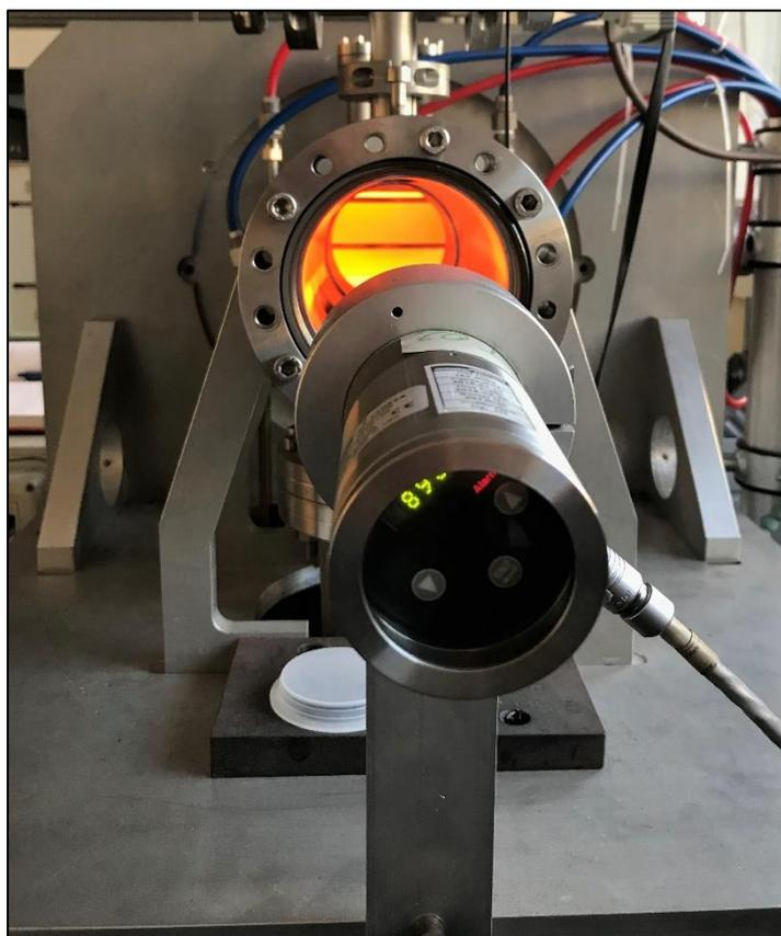
Figura 4. 36: Misura con pirometro LT durante un riscaldamento
