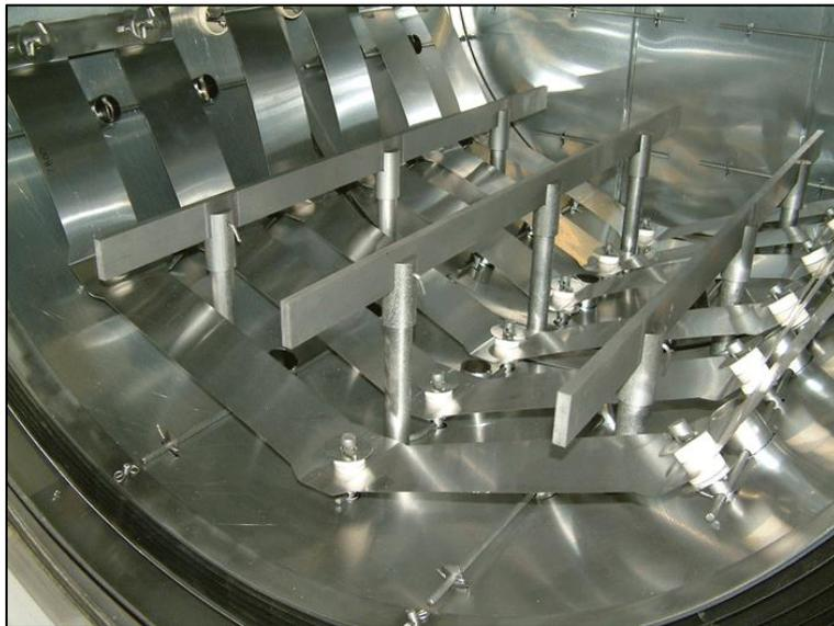
Figura 2. 8: Esempio di supporti in molibdeno
