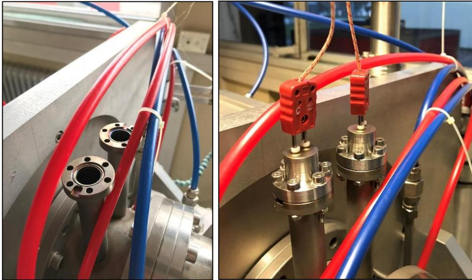
Figura 4. 15: Alloggiamento per i passanti e loro installazione
