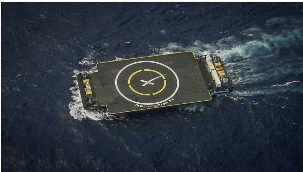
Figura 1.3: La piattaforma-drone autonoma OCISLY
