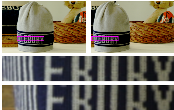
Fig. 3.7: in alto. Coppia di immagini acquisite da un sistema binoculare. In basso. Ingrandimenti delle aree evidenziate. La parte rivolta frontalmente alle fotocamere risulta quasi inalterata, mentre la veduta di scorcio nella parte di sinistra è causa di una sensibile distorsione dovuta al cambio di prospettiva (elaborazione di immagini tratte da http://vision.middlebury.edu/stereo/ ).
