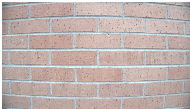
Fig. 2.1: per effetto della distorsione radiale si ottiene una curvatura delle linee rette, tanto più accentuata quanto più ci si allontana dal centro dell'immagine. In particolare le linee orizzontali non sono più parallele ai margini superiore e inferiore.
