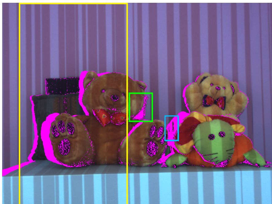
Fig. 5.7: anomalie nel dataset. L'area nella cornice verde non è occlusa, ma è in ombra rispetto al pattern proiettato e quindi praticamente al buio nel dataset che utilizza la sola luce del proiettore. L'area nella cornice celeste è occlusa nell'immagine di destra della coppia, ma in alcuni punti non risulta esserlo perchè l'algoritmo trova corrispondenze a basso costo in altri punti della parete (che sono invece visibili nell'immagine di destra e non in quella di sinistra). L'area nella cornice gialla è stata considerata per ripetere l'elaborazione, in modo da depurare la valutazione dello space-time stereo da queste anomalie.
