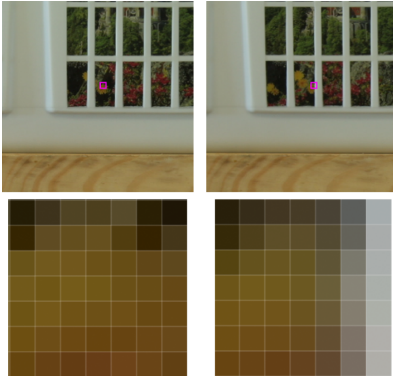
Fig. 3.4: influenza degli outliers sul costo di una corrispondenza. Le due finestre di dimensione 7x7 sono centrate su pixel corrispondenti, ma il cambio di prospettiva ha causato uno spostamento della discontinuità rispetto all'immagine sullo sfondo. La grande differenza tra i pixel delle colonne di destra determina un aumento del costo ed è una potenziale causa di errore (elaborazioni di immagini tratte da http://vision.middlebury.edu/stereo/ ).
