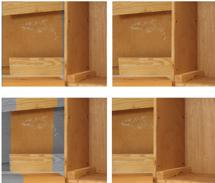
Fig. 1.7: In alto: coppia di immagini ottenute con una baseline corta. Nell'immagine di sinistra sono evidenziate (in bianco e nero) le superfici che non compaiono nell'immagine di destra. L'area grigia più a sinistra è esterna all'inquadratura della fotocamera di destra. L'area grigia al centro invece non è visibile nell'immagine di destra perché occlusa dalla particolare geometria della scena. In basso: coppia di immagini della stessa scena, ottenute però con una baseline più lunga rispetto alla figura precedente. Le aree non viste dalla fotocamera di destra si allargano di conseguenza (elaborazioni di immagini tratte da http://vision.middlebury.edu/stereo/data/ ).
