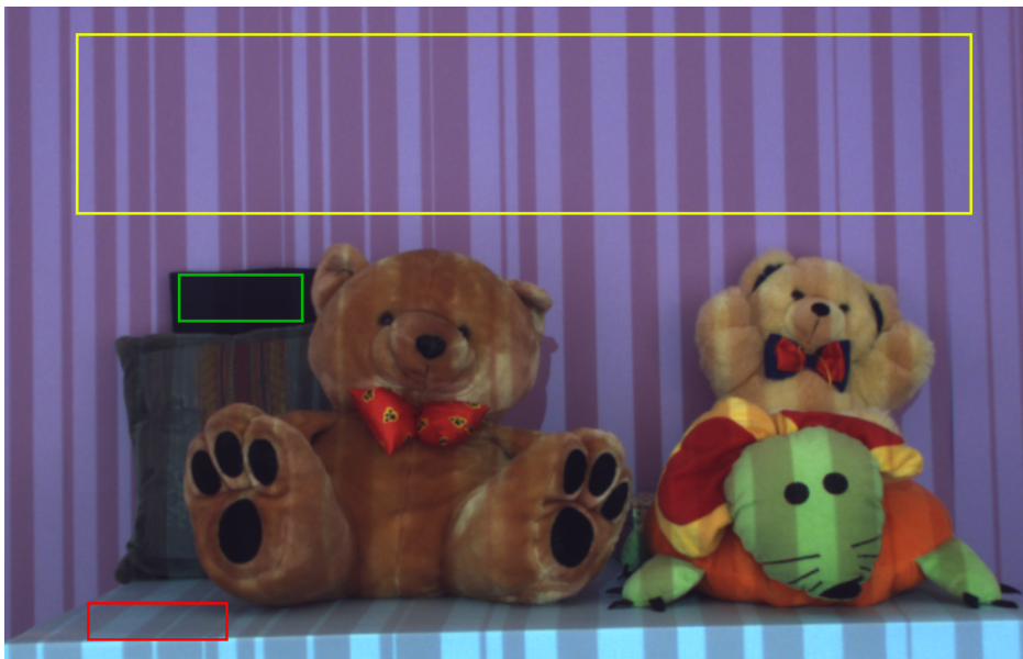
Fig. 5.11: la velocità dell'evoluzione verso il valore finale in aree diverse appare conseguenza dell'attitudine di una superficie a riflettere il pattern: rapida nell'area dentro la cornice gialla, più lenta nell'area dentro la cornice rossa e molto lenta (con permanenza di oclusioni) nell'area nella cornice verde.
