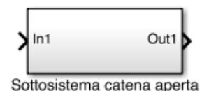
Adesso e ogni volta che sarà impiegato, il blocco “sottosistema catena aperta” sostituirà in tutto e per tutto l’insieme di blocchi memorizzati al suo interno.
