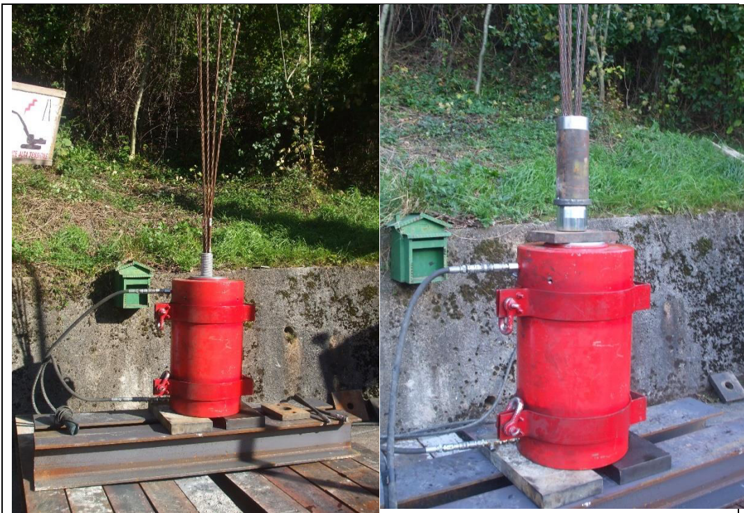
Figura 4.2, Posizionamento della strumentazione per prova di pull out
