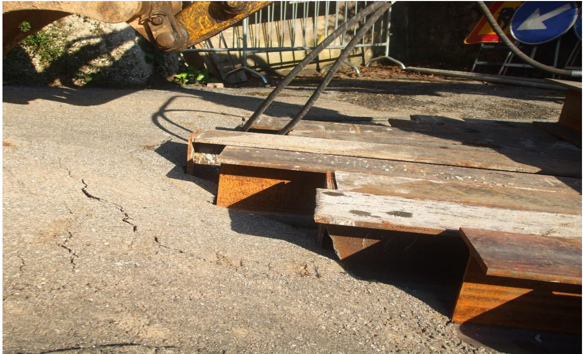
Foto 4.9, Cedimenti della "piastra" durante le prove di pull out
