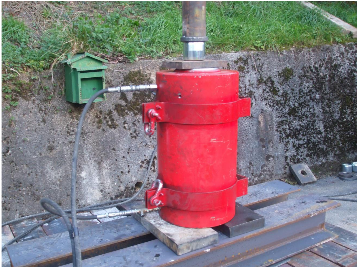
Foto 4.2, Martinetto utilizzato per la prova di pull out
