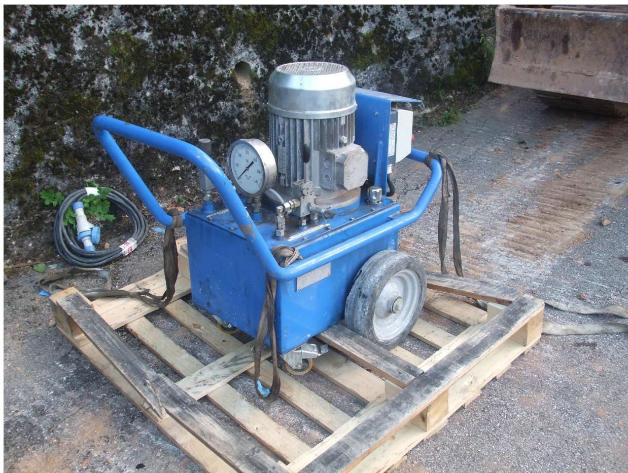
Foto 4.1, Centralina utilizzata per la prova di pull out
