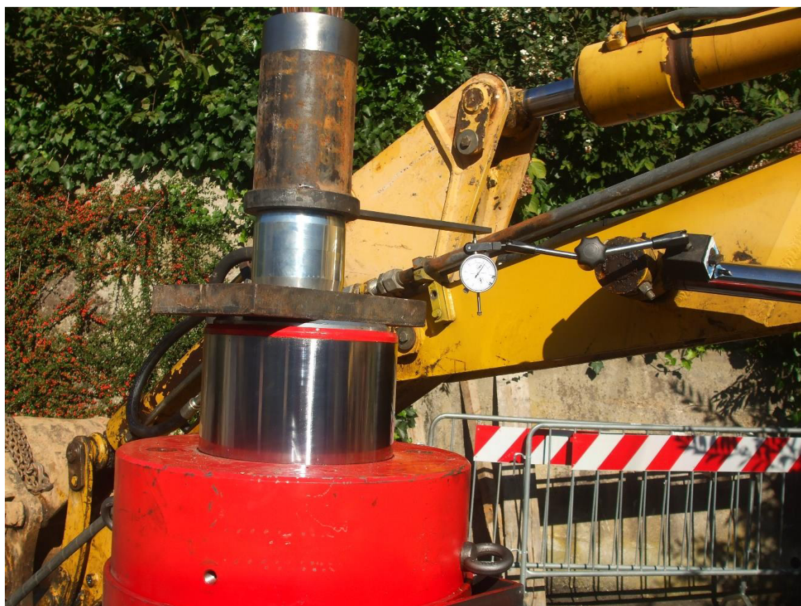
Foto 4.7, Posizionamento del comparatore per pull out su ancoraggio III
