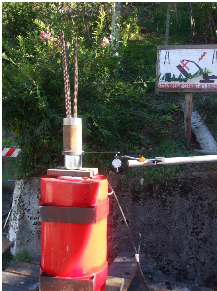
Foto 4.5, Posizionamento strumentazione ancoraggio II
