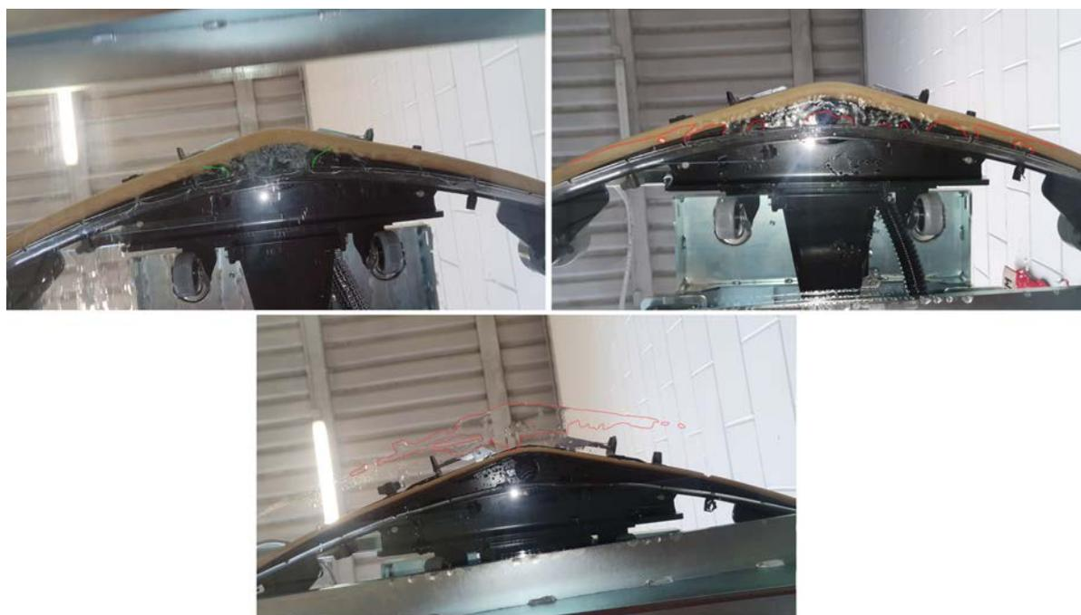
Figura 27: Immagine della successione delle fasi del processo di asciugatura per il tergipavimento A.4 con le fessure laterali chiuse.
