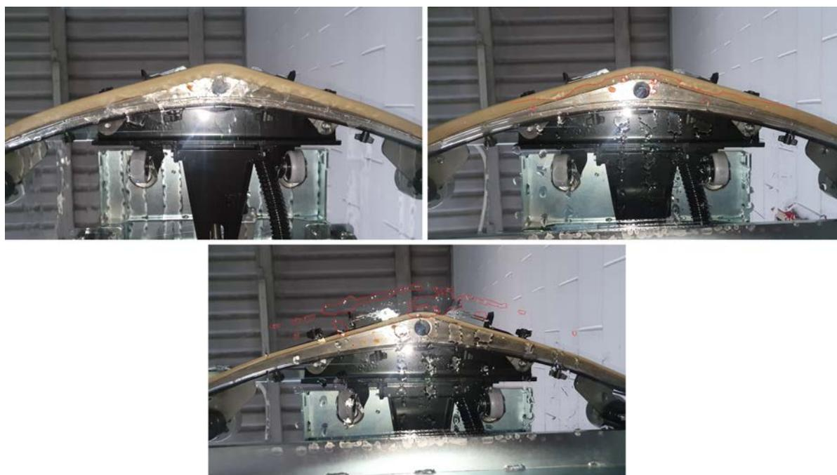
Figura 33: Immagine della successione delle fasi del processo di asciugatura per il tergipavimento B.3 con le fessure laterali chiuse.
