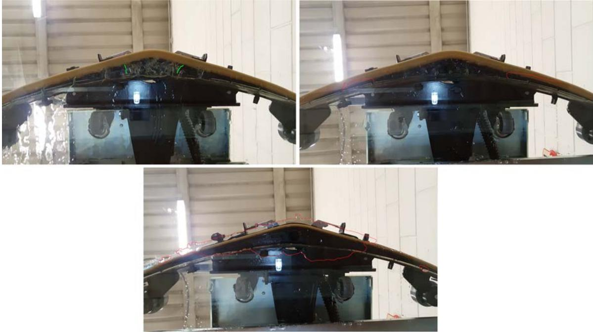
Figura 30: Immagine della successione delle fasi del processo di asciugatura per il tergipavimento in configurazione A.3, ottenuta inserendo nella parte cilindrica di raccordo con il tubo di aspirazione una riduzione in PVC costruita in modo da arrivare fino all'apertura sulla camera di aspirazione. Si riportano in alto un'istantanea del moto stazionario (a sinistra) e della condizione finale (a sinistra), e in basso l'acqua residua a fine operazione.
