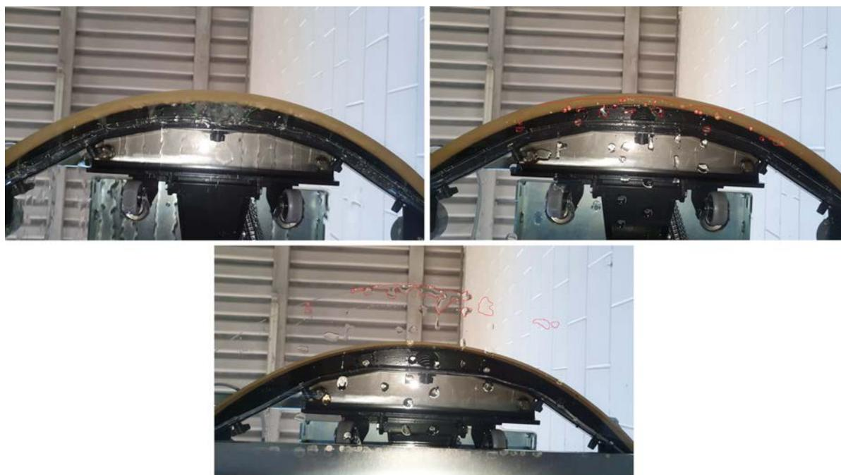
Figura 34: Immagine della successione delle fasi del processo di asciugatura per il tergipavimento C.4, montato sulla macchina *Jade* prodotta da *Adiatek*. In alto a destra si mostra la fase di moto stazionario, a sinistra la condizione finale, e in basso l'acqua residua sul vetro dopo il sollevamento del tergipavimento.
