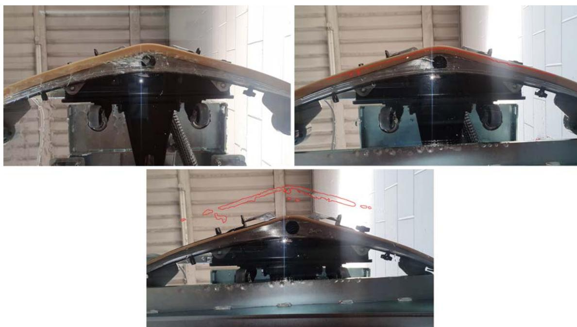
Figura 28: Immagine della successione delle fasi del processo di asciugatura per il tergipavimento B.4, realizzato saldando una piastra di chiusura sotto alla camera di aspirazione di un tergipavimento del tipo A.4 già esistente. Si mostrano, in senso orario, partendo da in alto a destra, la fase di moto stazionario, la condizione finale, e l'acqua residua sul vetro dopo il sollevamento del tergipavimento.
