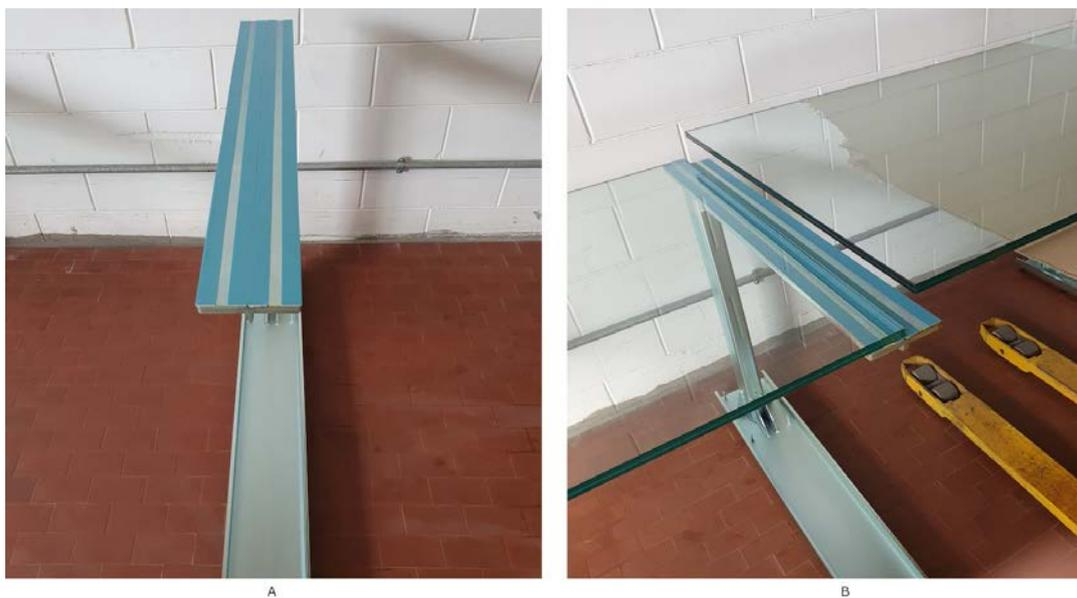
Figura 22: Aggiustamento della posizione dei cavalletti: A) applicazione delle strisce di nastro biadesivo sulla faccia superiore; B) appoggio della lastra di vetro per assicurare il contatto con la lastra successiva.
