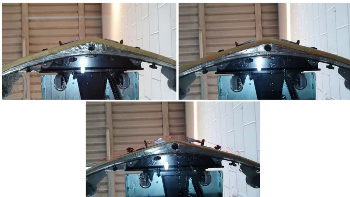
Figura 32: Immagine della successione delle fasi del processo di asciugatura per il tergilavaggio B.3, realizzato come variante di B.4 con un elemento di raccordo col tubo di aspirazione di diametro minore. Partendo da in alto a sinistra, sono riportate immagini di moto stazionario, condizione finale, acqua residua.
