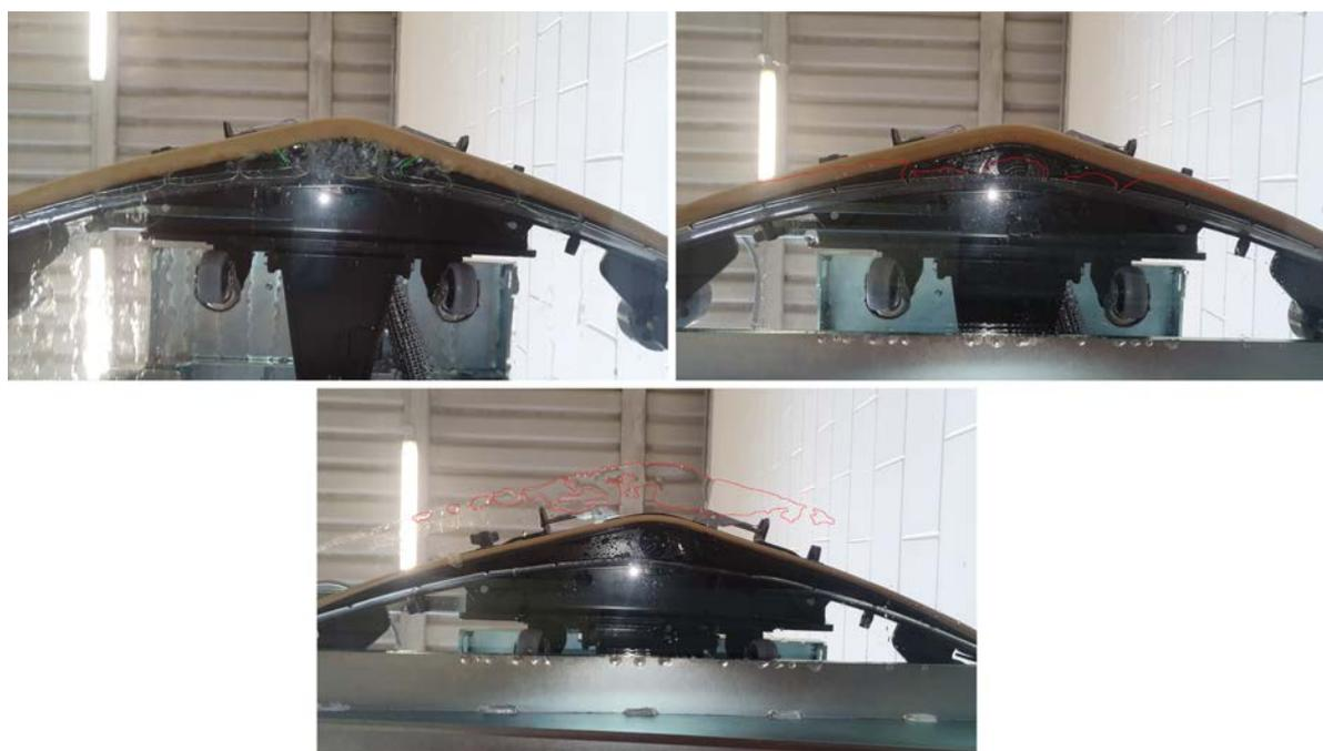
Figura 26: Immagine della successione delle fasi del processo di asciugatura per il tergipavimento A.4 (il modello attualmente utilizzato sulle macchine *Quartz* di *Adiatek*): in alto a destra si mostra la fase di moto stazionario, a sinistra la condizione finale, e in basso l'acqua residua sul vetro dopo il sollevamento del tergipavimento.
