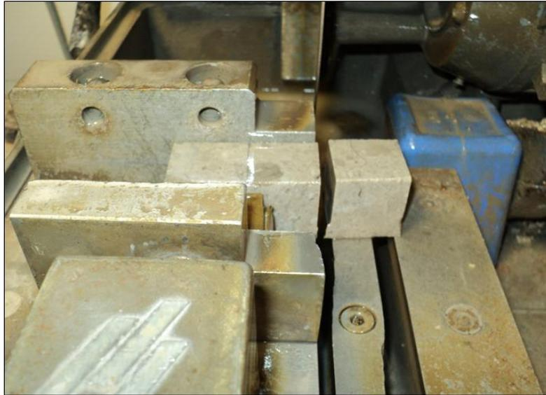
**Figura 4.2.3:** *Operazione di taglio per test proprietà fisiche su campione POZZO TI 5*
