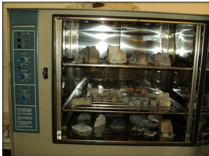
**Figura 4.2.4:** *Fase di essiccazione in forno dei campioni analizzati*
