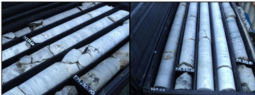
**Figura 3-4:** cassetta catalogatrice per POZZO TI 4 e POZZO TI 5
