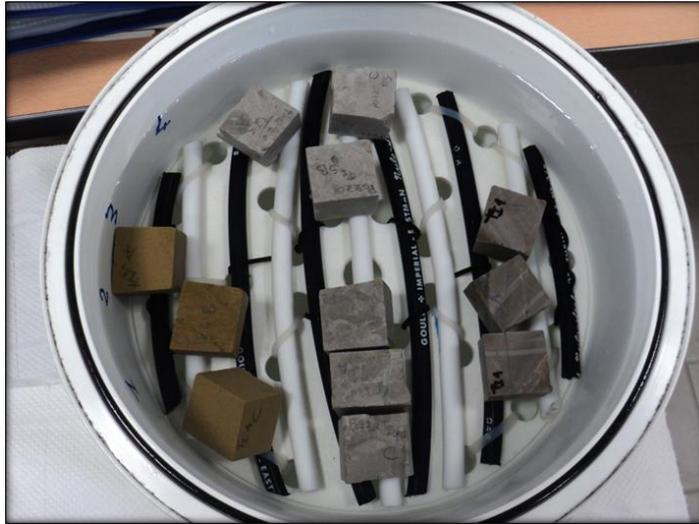
**Figura 4.3.5:** Apertura essiccatore dopo che i campioni saturi hanno raggiunto l'equilibrio con la pressione atmosferica
