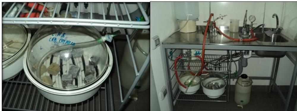
**Figura 4.3.4:** *Procedura di degassazione*
