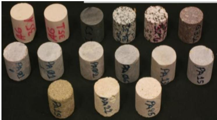
**Figura 4.5.1:** *Provini cilindrici pronti per le misure di resistività elettrica (Norbert Klitzsch & Lothar Ahrensmeier)*
