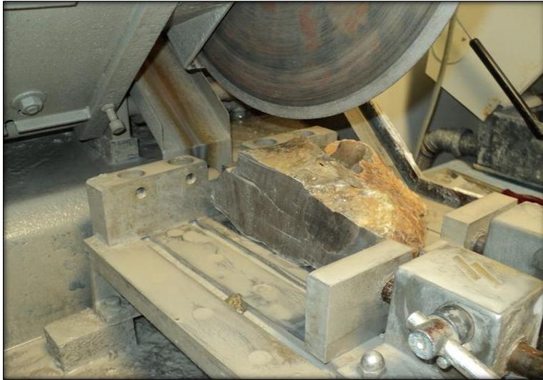
**Figura 4.2.1:** *Operazione di taglio sul campione TI 1*
