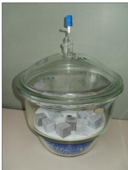
**Figura 4.3.1:** Essiccatore contenente i provini
