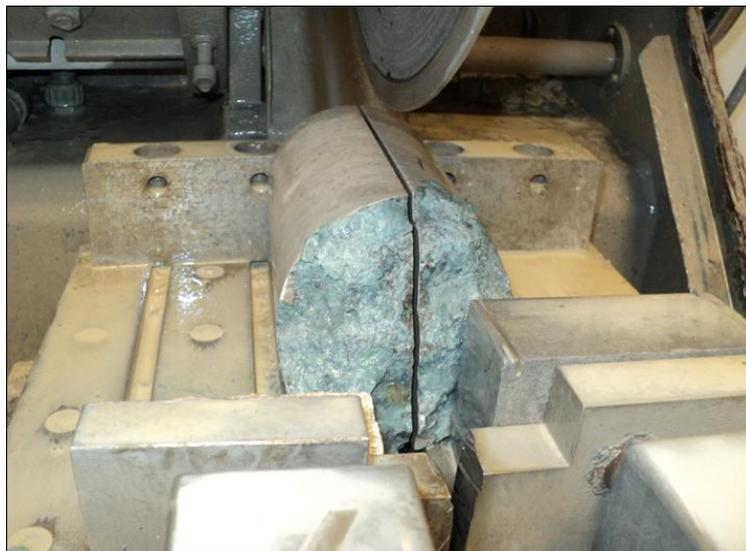
**Figura 4.2.2:** *Operazione di taglio su carota dalla quale è stato estratto il campione POZZO TI 5*
