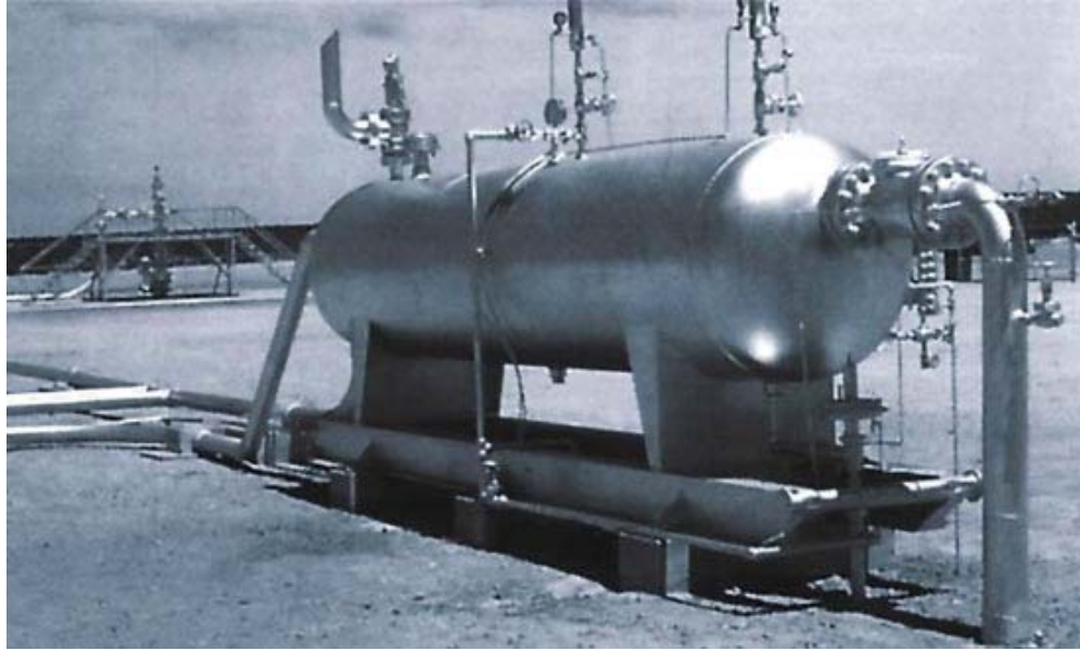
Figura 4.4 – Separatore orizzontale ad un corpo
