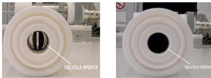
Figura 19 – Dispositivo contenente la valvola di non ritorno: sezione interna con valvola aperta (sx) e chiusa (dx).
