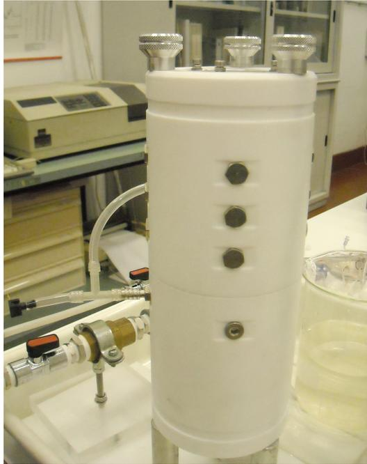
Figura 15 - Camera di coltura in Teflon® [11].
