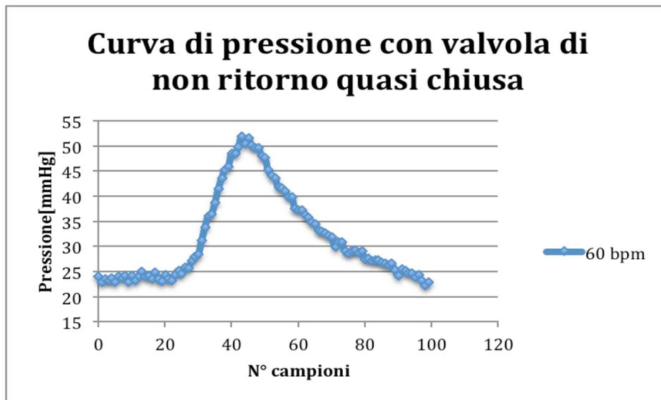
Figura 25 – Andamento della curva di pressione acquisita in compliance, ad una pressione di 60 bpm e con un'ampiezza di oscillazione di 0.5 cm, quando il rubinetto della valvola di non ritorno è quasi chiuso.
