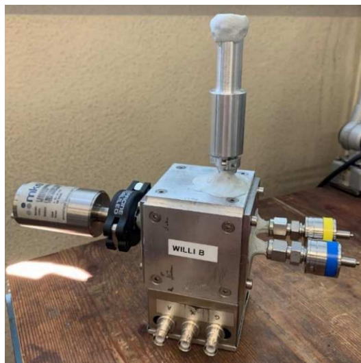
Figura 3.1: Immagine del rivelatore Willi-B in cui è possibile notare il detector e il supporto di acciaio su cui è agganciato [5].
