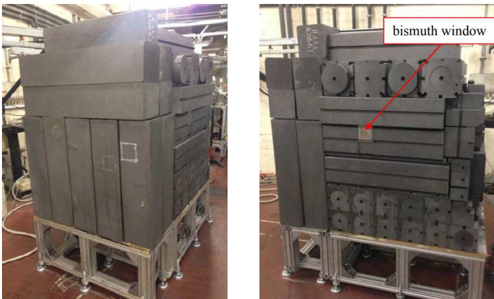
Figura 3.2: Moderatore all'acqua pesante e grafite BSA (Beam Shaping Assembly) di MUNES. Nell'immagine di destra è visibile il canale di uscita in bismuto [5], [8].
