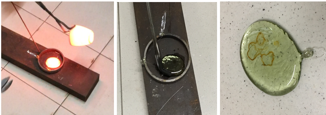
Figura 4.4. Fasi di realizzazione del vetro, dalla colata su stampo al prodotto finale solidificato.
