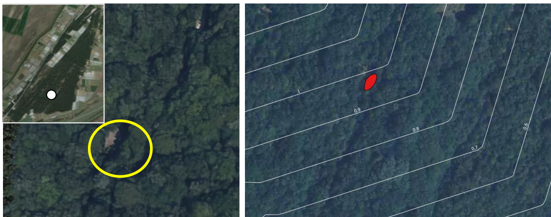
Figura 3.17: Foto di sinistra: vista da Google Earth della radura 3, Foto di destra vista da QGIS della radura 3 con curve di livello (equidistanti 10 cm).
