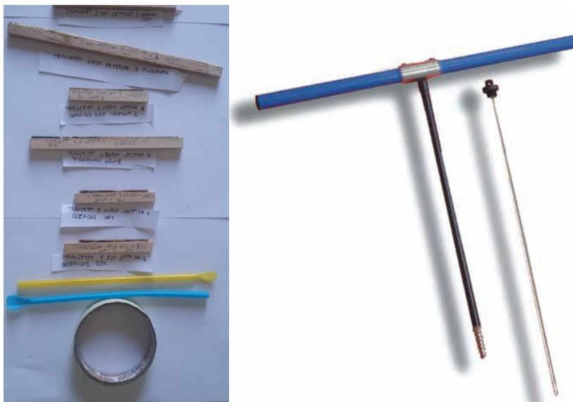
Figura 2.14: Foto di sinistra: carotine catalogate e protette nel trasporto con cannucce da granita e nastro adesivo. Foto di destra: succhiello di Pressler utilizzato per l'estrazione delle "carotine".
