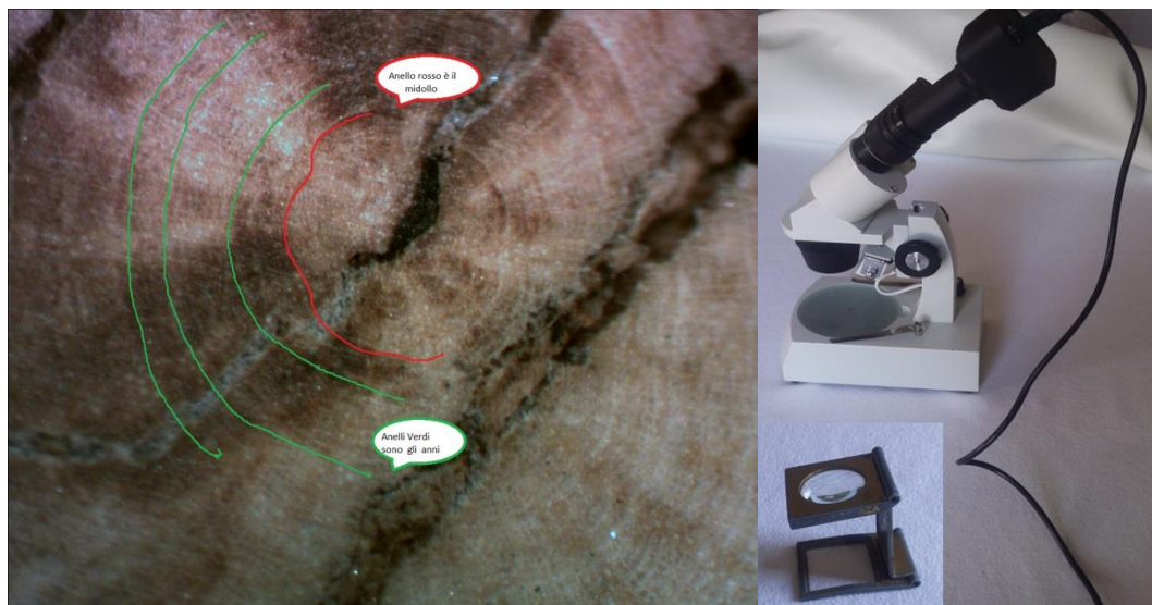
Figura 2.15: Foto di sinistra: immagine tratta dal microscopio stereoscopico, sezione trasversale di una rotella di Quercus ilex esemplificata con paint. Foto di destra: microscopio stereoscopico e lente entomologica.
