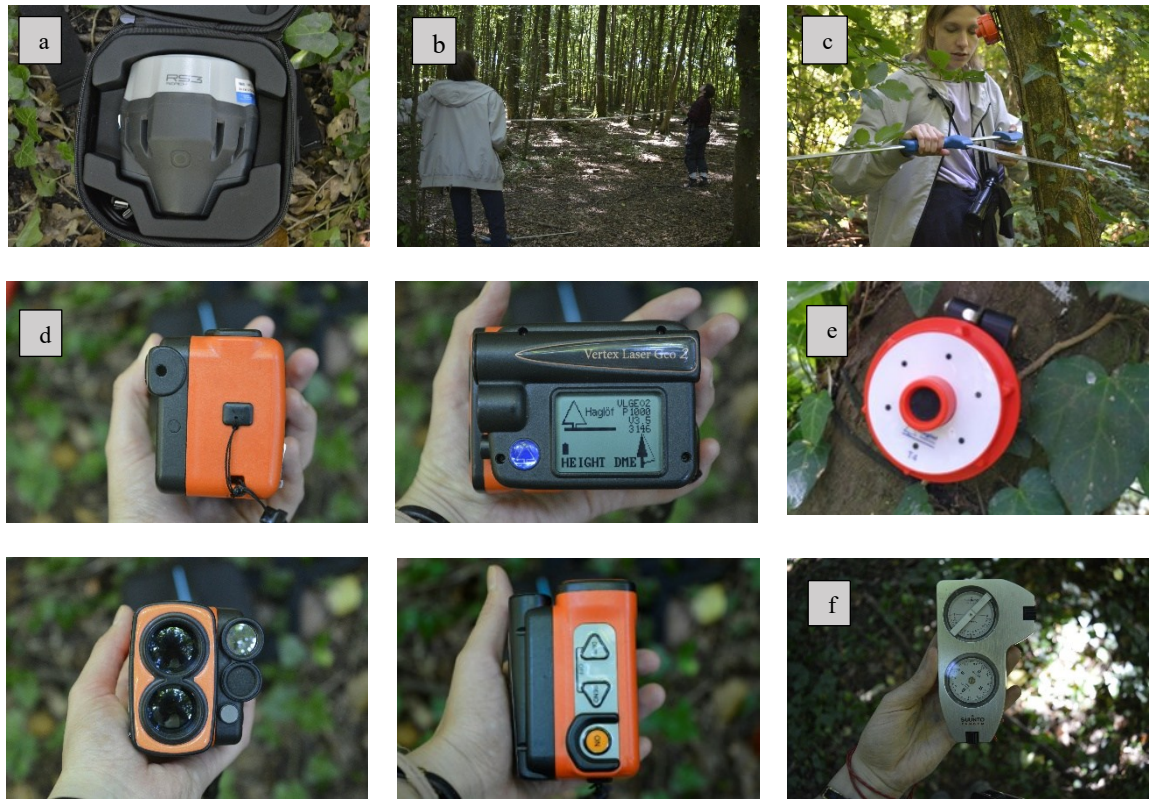
Figura 5: Materiali: (a) ricevitore GPS/GNSS Haglöf RS3, (b) misurazione della proiezione della chioma con cordella metrica, (c) rilievo del DBH con cavalletto dendrometrico (d) Vertex, (e) Transponder, (f) Suunto Tandem/360PC/360R G Clino/Bussola.
