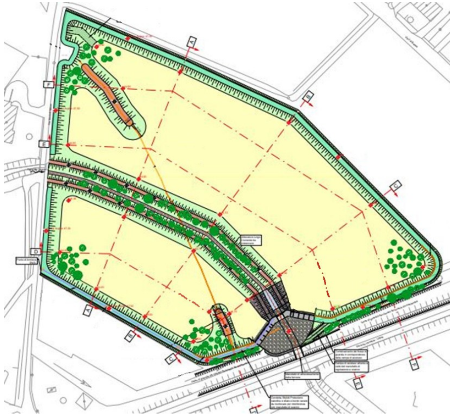
Figura 6: Bacino di espansione a monte della ferrovia. (Fonte: Relazione Generale e Illustrativa - sistemazione idraulica canale Codolo)
