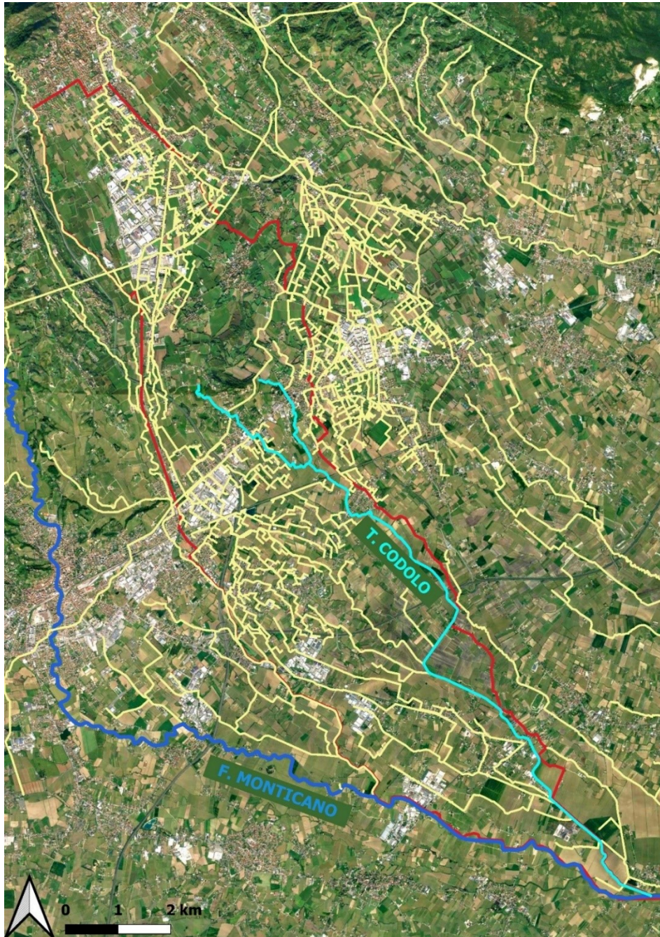
Figura 22: Canali della rete idraulica secondaria (in giallo); dominio di calcolo in rosso.
