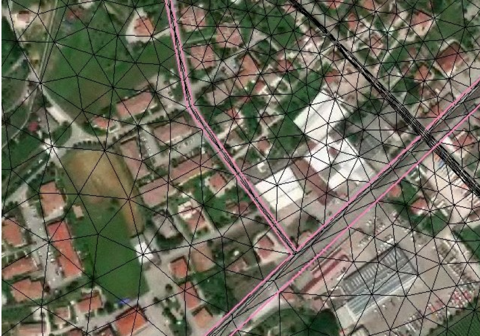
Figura 21: Esempio di definizione di elementi appartenenti alla rete di viabilità stradale principale (in rosa) rispetto al piano campagna circostante.
