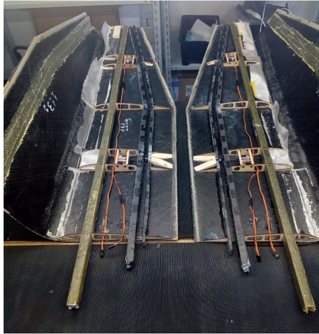
Figura 10.2: Foto che raffigura la struttura interna dell'ala prima della chiusura dei laminati in pannello sandwich che compongono il mantello.
