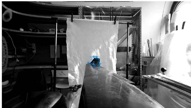
Figura 8.10: In blu i cerchi che contengono le informazioni rilevate dal descrittore all'interno della ROI = [x = 540y = 320l = 180h = 250] .
