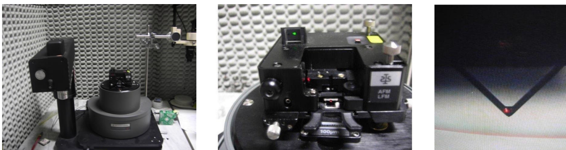
Figura 4.6: Foto a sx: apparecchiatura per AFM. Foto al centro: particolare della testa dell' AFM. Al centro si nota il cantilever illuminato dallo spot rosso del laser. Sotto ad esso risiede il campione. Foto a dx: Ingrandimento al microscopio del cantilever
