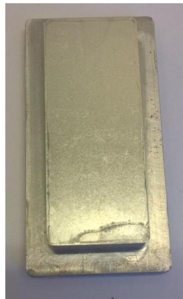
*Figura 5.6: Fotografia del rivestimento superficiale di P7T3\_2\_200: (a) prima dell'esposizione in impianto, (b) dopo l'esposizione in impianto di scambio termico.*
