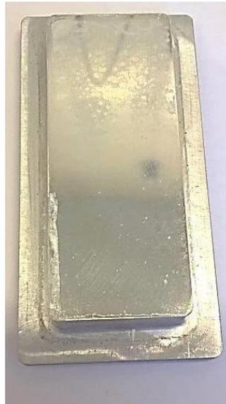
**Figura 5.12:** Fotografia del rivestimento superficiale di P7T3\_3\_400 dopo l'esposizione in impianto di scambio termico.
