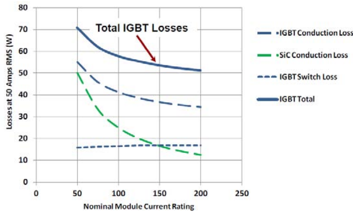
Figura 6.4.11: Confronto delle perdite di commutazione tra MOSFET al SiC e IGBT al silicio.
