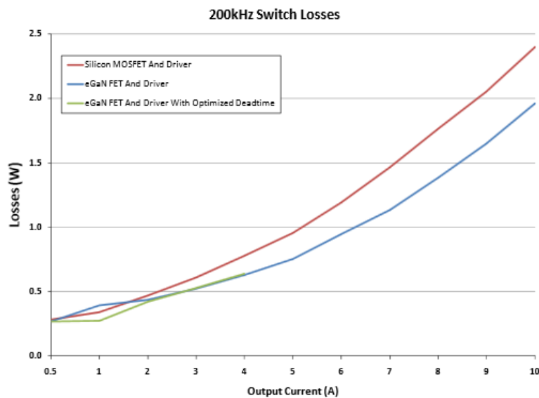
Figura 6.3.10: Confronto delle perdite tra FET in eGaN e MOSFET al silicio nel convertitore buck di test.
