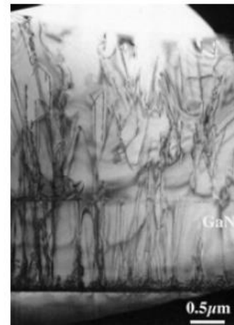
Figura 2.4.3 (sinistra): Controllo di orientazione di substrati cresciuti su GaN tramite HVPE
