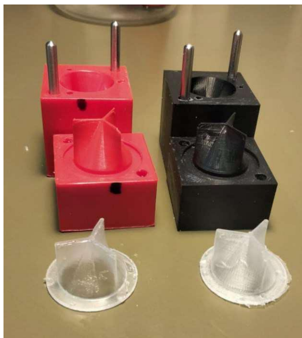
Figure 4.17: Prima coppia di valvole siliconiche.
