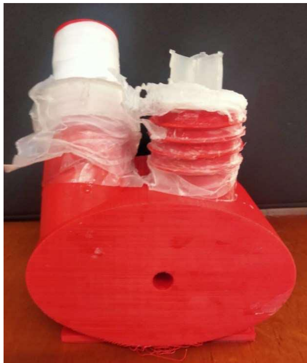
Figure 4. 20: Valvola di inlet estroflessa (vista laterale).
