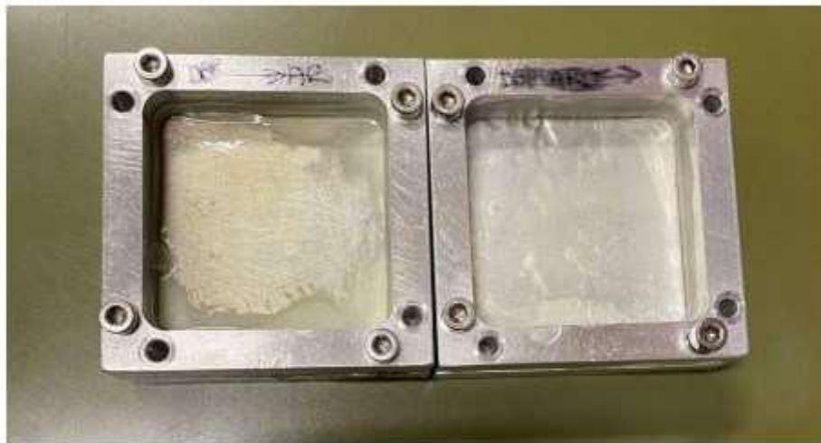
Figura 2.1: Membrana ibrida ottenuta per solvent casting.
