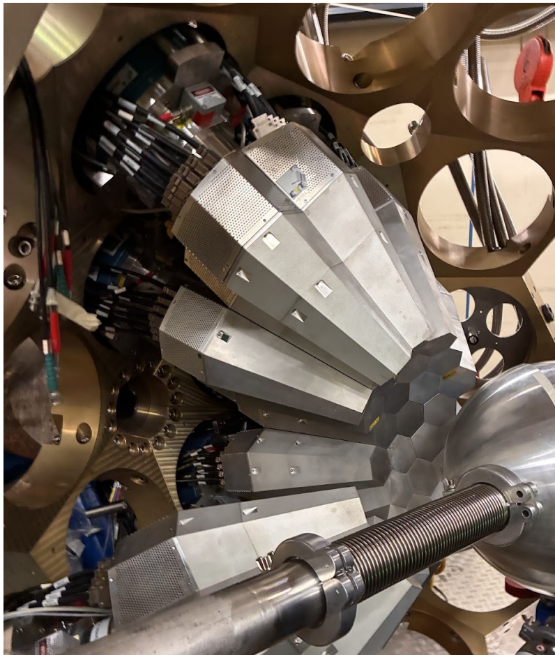
Figura 9: Foto dello spettrometro AGATA nella sua configurazione durante la campagna sperimentale EXOTIC.
