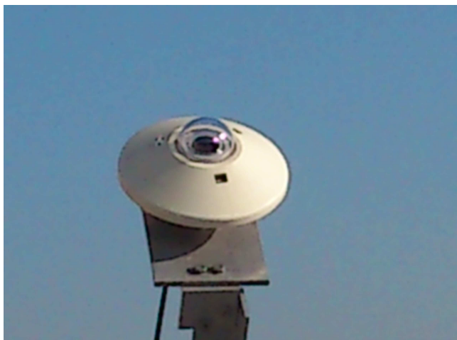
Figura 2.5 – Piranometro per la misura della radiazione sul piano dei collettori
