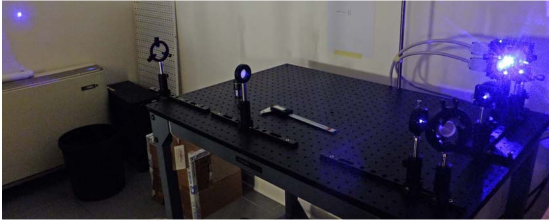
Figura 4.28: Setup di misura della sorgente LASER Nichia NDB7352.
