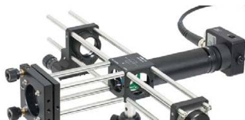
Figura 4.31: Esempio di applicazione del cage-system Thorlabs.
