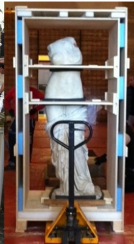
Fig. 13 - transpallet durante la movimentazione di un bene culturale (da http://www.demarinisfineart.it/servizi.asp?servizioid=2&hl=it&MenuID=6 )
