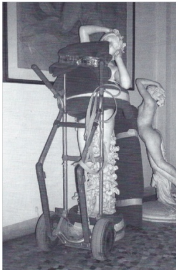
Fig. 9 - Carrello impilatore per il trasporto di una scultura, (da Fratelli 2017, 304)
