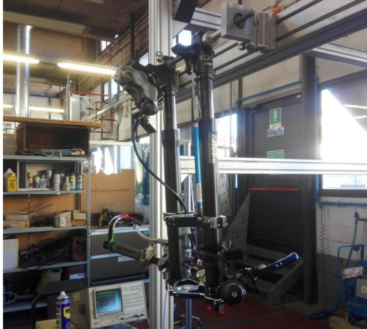
Figura 1.7: Fissaggio avantreno per la misurazione della frequenza di beccheggio
