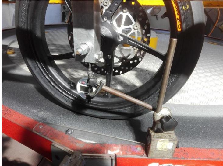
*Figura 1.19: Misurazione degli spostamenti verticali*
