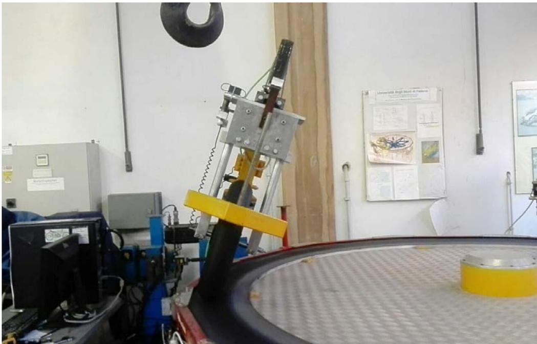
Figura 1.15: Prova di rollio
