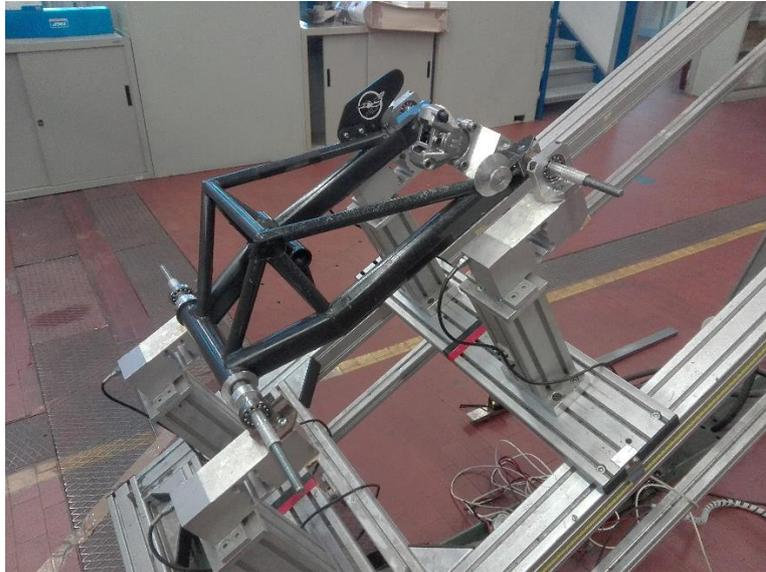
Figura 1.9: Misurazione del baricentro del retrotreno
