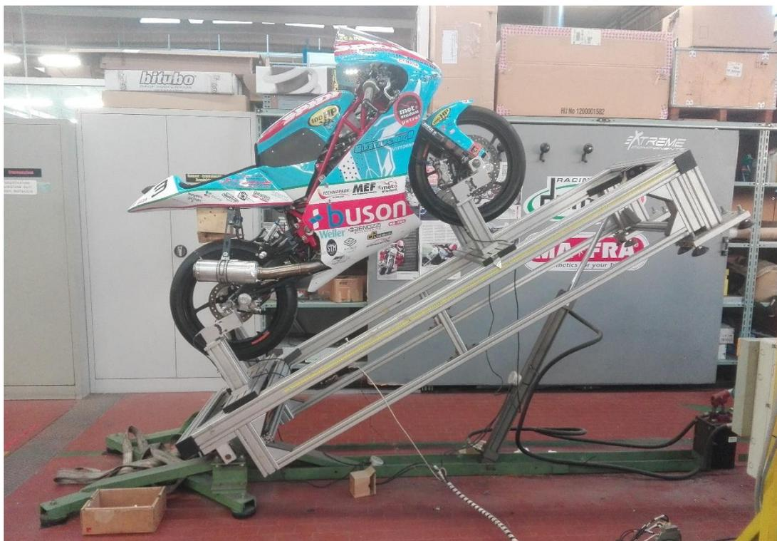
Figura 1.3: Motociclo MS2018 sul banco di misura del baricentro
