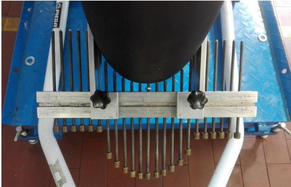
Figura 1.23: Misurazione del raggio del toroide
